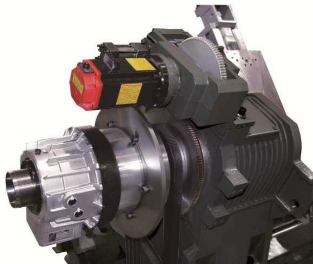
Obr. 10 - Provedení C – osy soustruhu Goodway [14]
