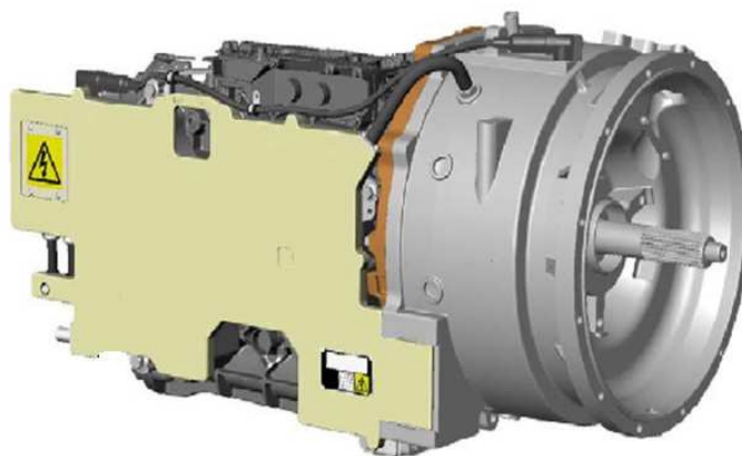
Obr. 10: Přebodovka Volvo I-shift AT2412D1 se zabudovaným elektromotorem/generátorem a AC/DC měničem. [1]
