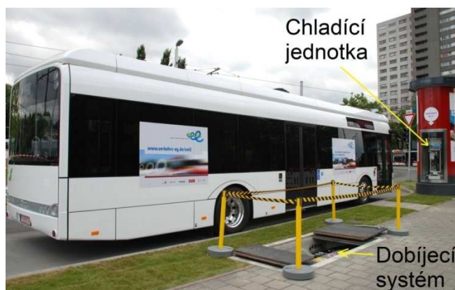
Obr. 41: Zastávka v Braunschweig. [78]
