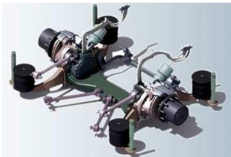
Obr. 34: Elektromotory jsou umístěny v nábojích kol. [76]
