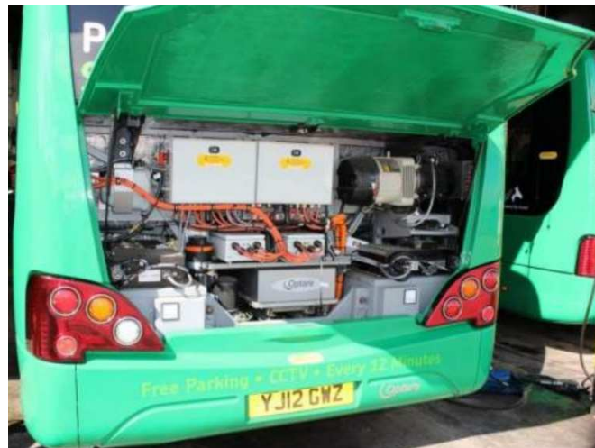
Obr. 29: Pohled na umístění komponentů elektrického pohonu. [67]
