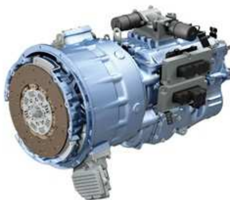
Obr. 9: Přebodovka Eaton EH-8E406A-CD se zabudovaným elektromotorem/generátorem. [43]
