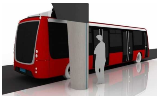
Obr. 36: Projekt nabíjecího stojanu 150 kW firmy SOR. [69]
