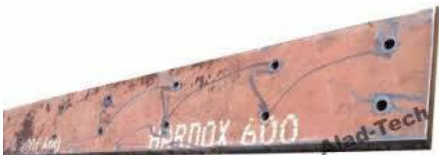
Obr 7: Břít dozerové radlice z materiálu Hardox 600 [12]
