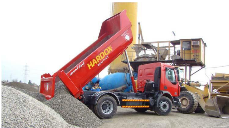
Obr 5: Korba nákladního automobilu vyrobená z Hardox 450 [13]
