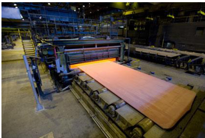
Obr 8: Válcování plechu v železárnách Ruukki [14]
