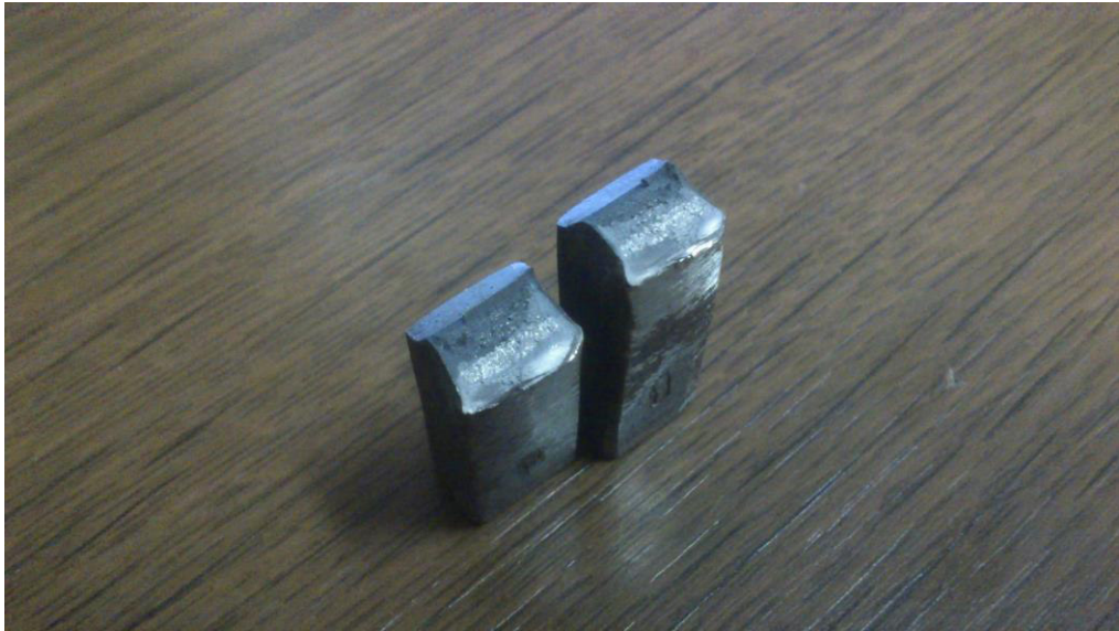
Obr 25: Detail lomu zkušebního vzorku
