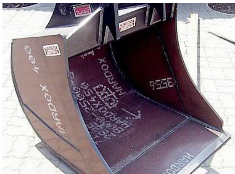
Obr 4: Použití Hardoxu 400 na konstrukční části lžice rypadla [11]
