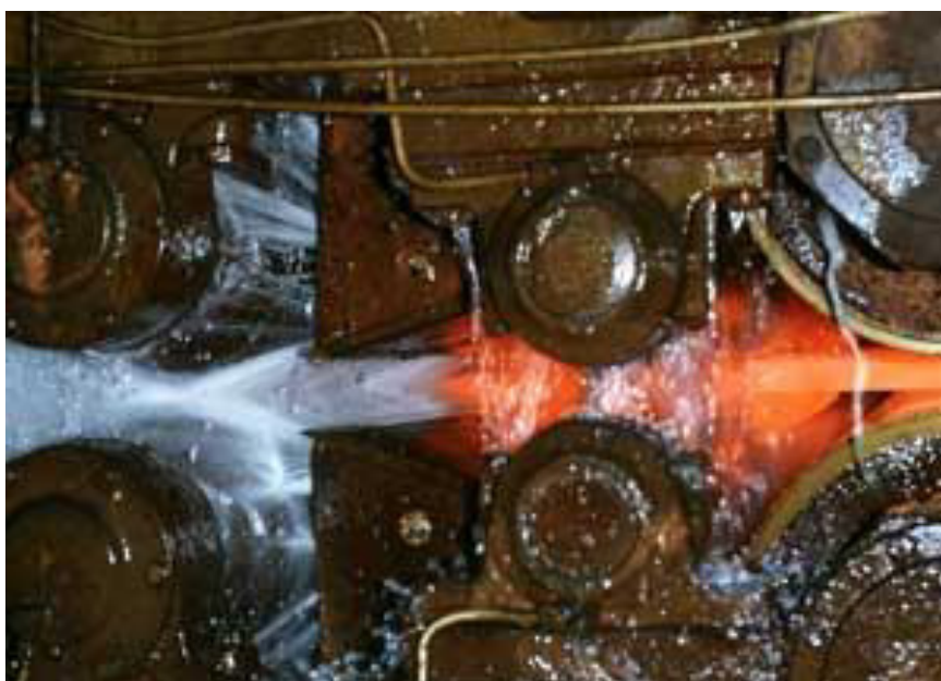
Obr 3: Kalení tabule plechu ve vodní sprše prováděné na kalící lince firmy SSAB Oxelosund [14]
