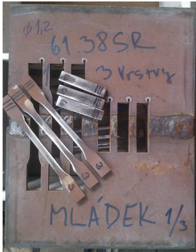
Obr 19: Zkušební tělesa po vyříznutí vodním paprskem
