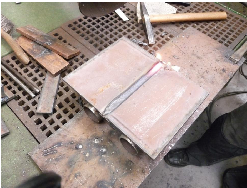
Obr 15: Kořenová vrstva svaru – lící strana vzorku
