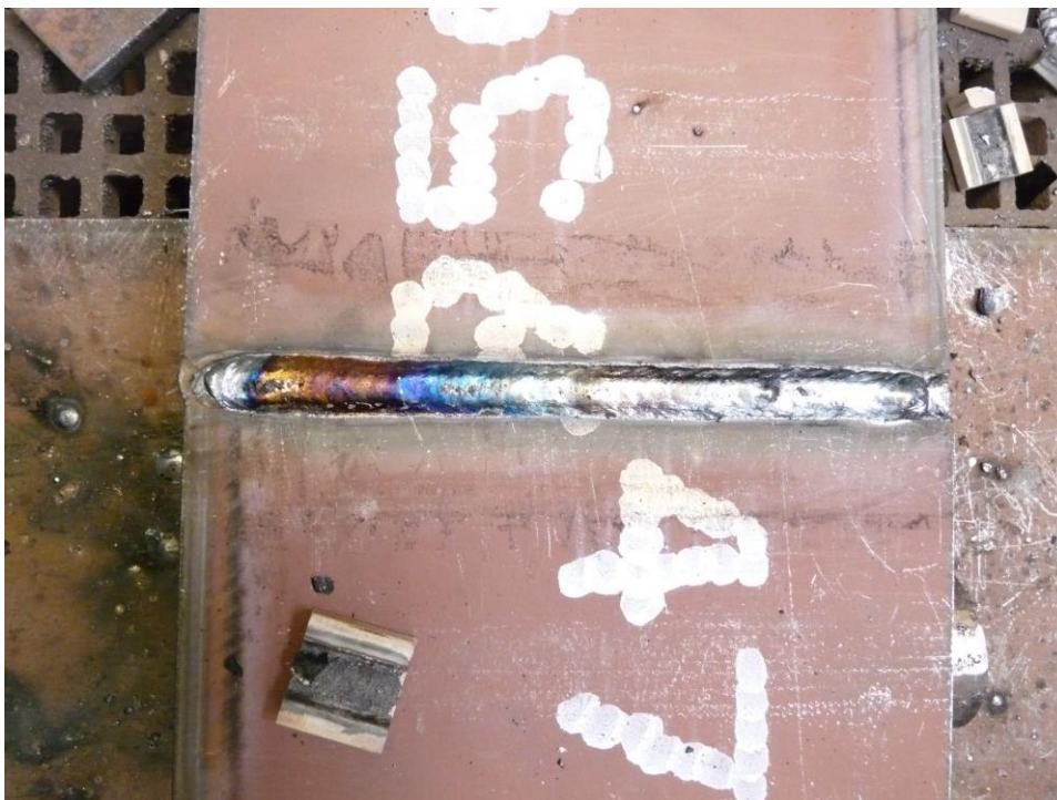
Obr 16: Kořenová vrstva svaru po odstranění podložek – rub vzorku
