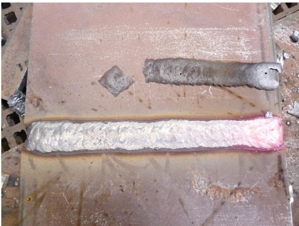
Obr 17: Krycí vrstva třívrstvého svaru po odstranění strusky
