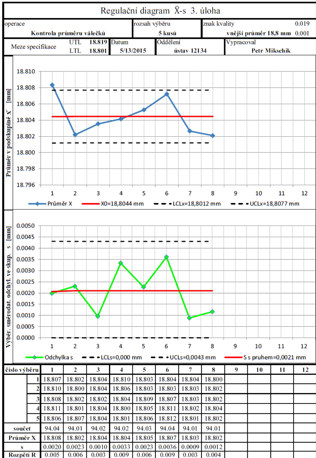
Obrázek 37– Regulační diagram zobrazující průměr v podskupině a výběrovou směrodatnou odchylku v podskupině 3. úloha
