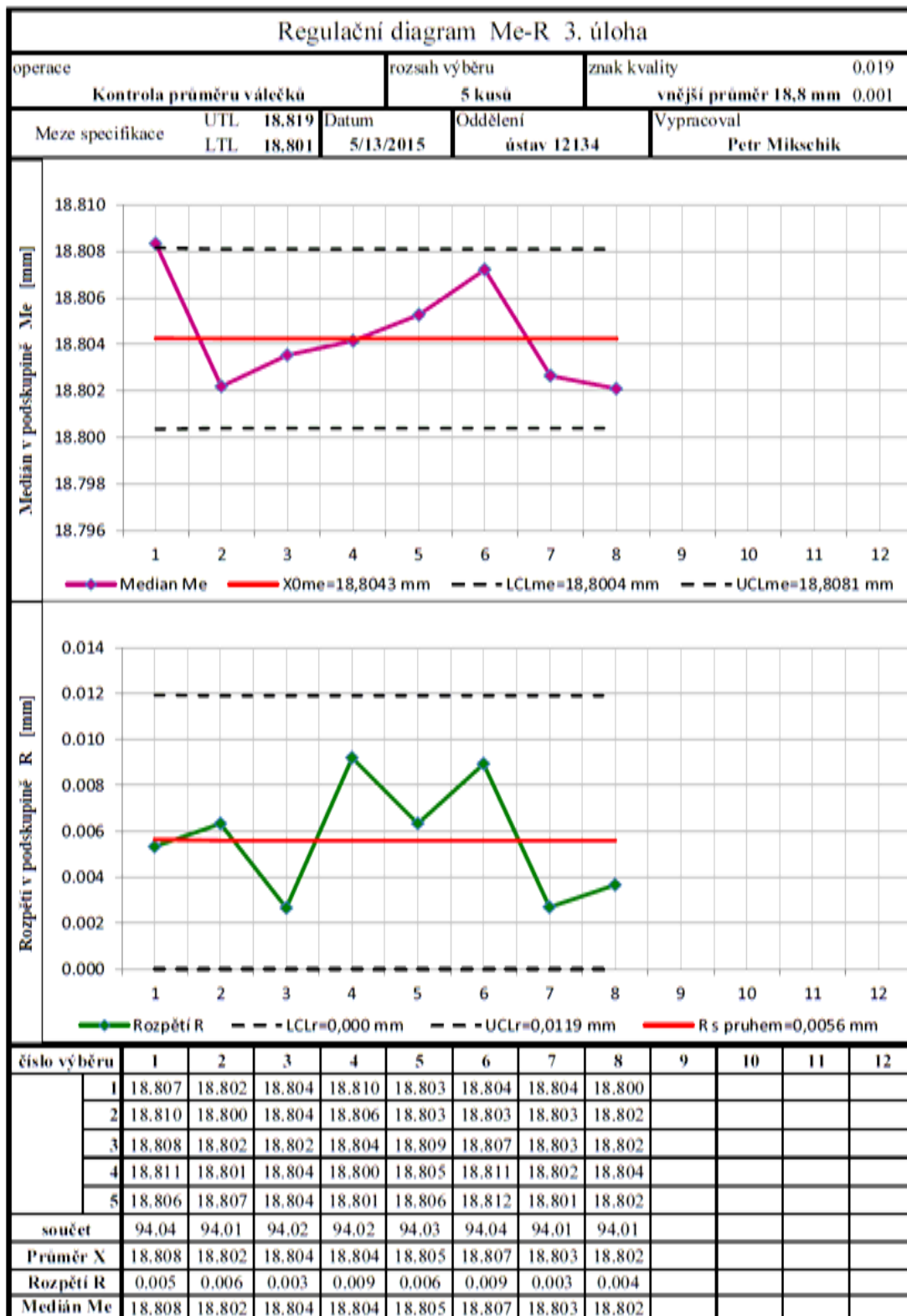
Obrázek 38– Regulační diagram zobrazující medián v podskupině a rozpětí v podskupině 3. Úloha
