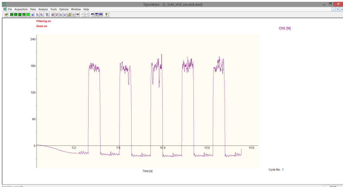
Obrázek 7.29 – Snímek obrazovky ze záznamu měření posuvové síly na začátku cyklu, materiál SF30.
