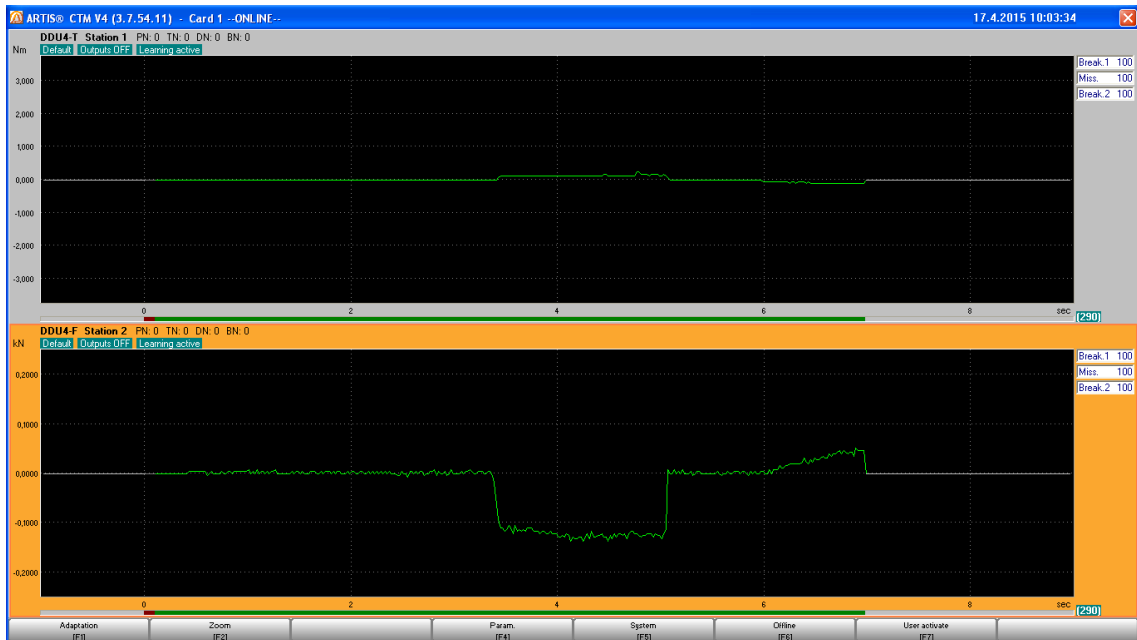
Obrázek 7.14 – Záznam měření síly v ose Z a krouticího momentu pomocí systému DDU-4 WiSy.
