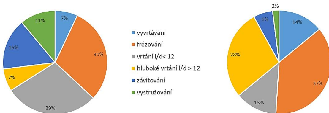
Obrázek 2.1 – Zastoupení technologií dle počtu prováděných operací (vlevo) a spotřeba strojního času dané technologie (vpravo).
