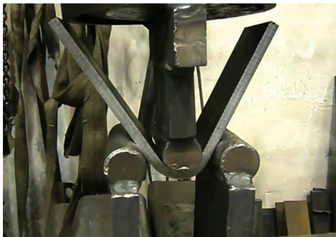
Obrázek 3.5 - Princip zkoušky ohybem [6]
