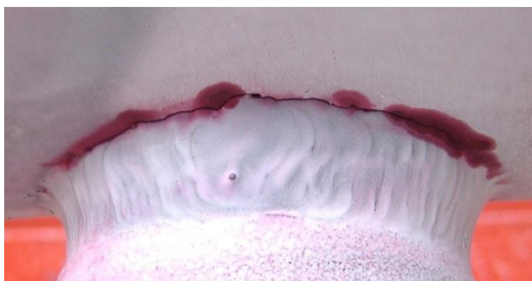
Obrázek 3.1 - Princip kapilární zkoušky [2]
