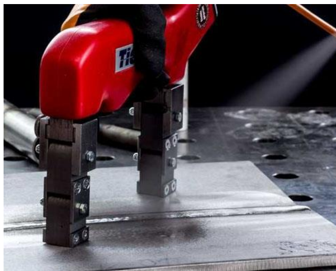
Obrázek 3.2 - Princip magnetické práškové metody [3]
