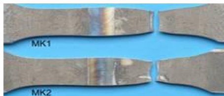
Obrázek 3.4 - Zkoušení svarových spojů tahem [5]
