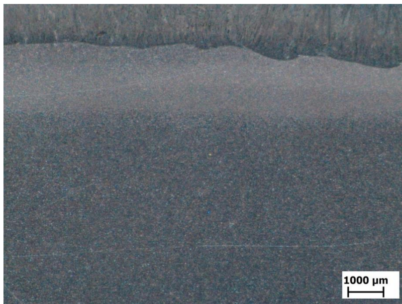
Obr. 26 Přejíhodová oblast s tepelně ovlivněnou oblastí
