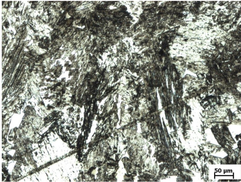
Obr. 41 Struktura první návarové vrstvy zvětšení 100x
