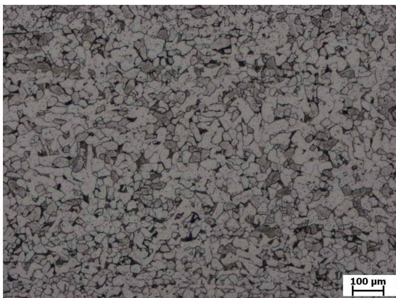
Obr. 32 Mikrostruktura vyžíhané oblasti zvětšení 50x
