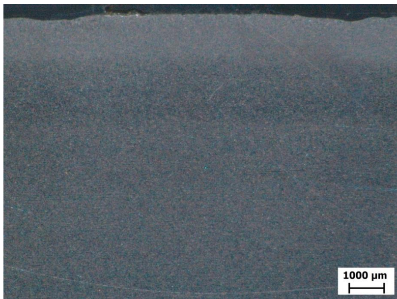
Obr. 28 Přechodová oblast s tepelně ovlivněnou oblastí
