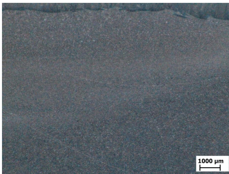
Obr. 24 Přejíhodová oblast s tepelně ovlivněnou oblastí
