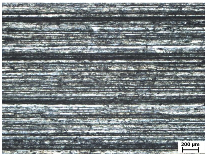
Obr. 19 Rýhovaný povrch vzorku č. 8 po zkoušce
