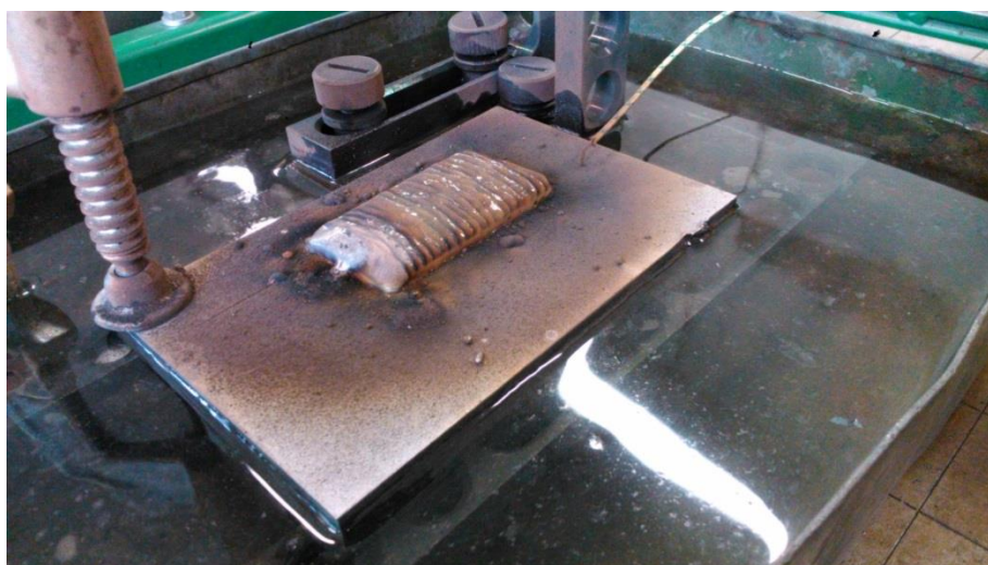
Obr. 15 Vzorek po navaření s vodním ochlazováním
