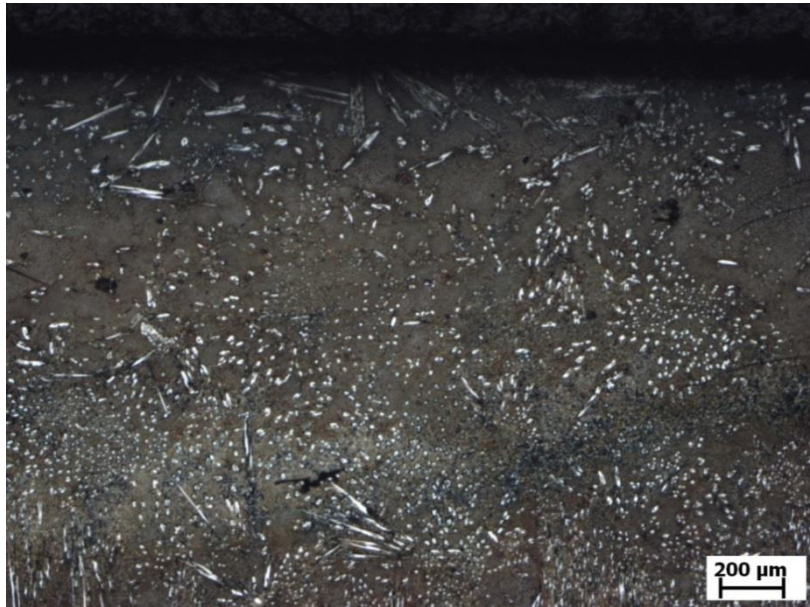
Obr. 48 Druhá vrstva s kontaktní plochou po zkoušce abrazivního opotřebení zvětšení 50x
