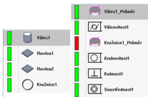
Obrázek 25: Vlevo základní geometrické prvky/ Vpravo měřené charakteristiky
