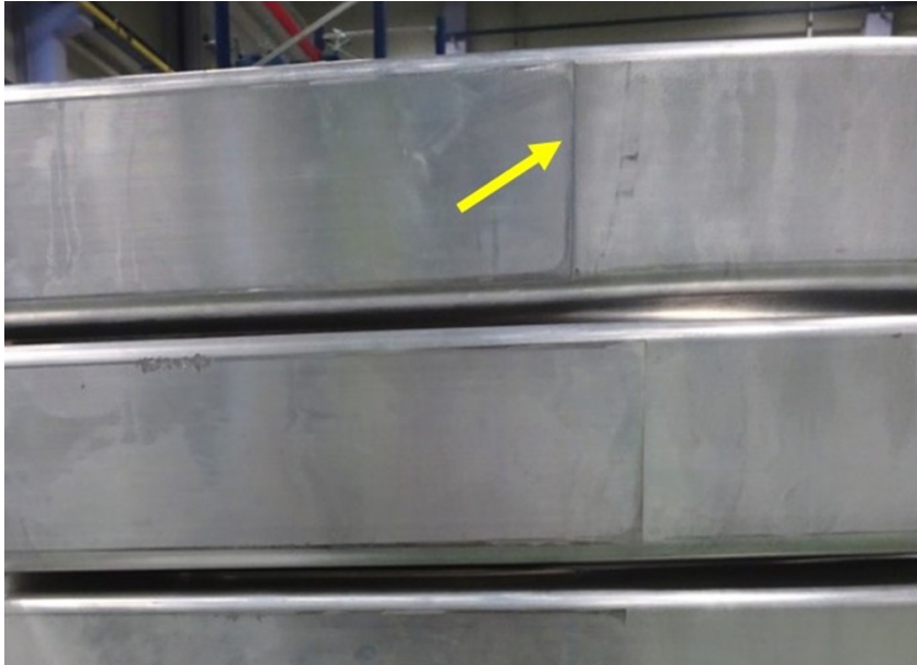
Obrázek 4.4-02: Vada A - otlaky na vnější ploše kratší části
