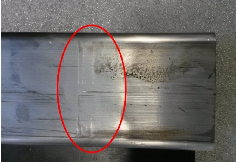
Obrázek 4.2-09: Vada E - otlak způsobený kleštinami
