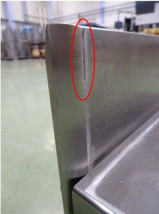
Obrázek 4.3-05: Závěr přítlaku po úpravě s nárůstkem
