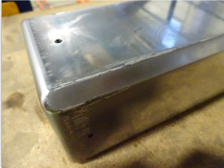
Obrázek 4.6-04: Nalepená slitina hliníku na hranách trnu
