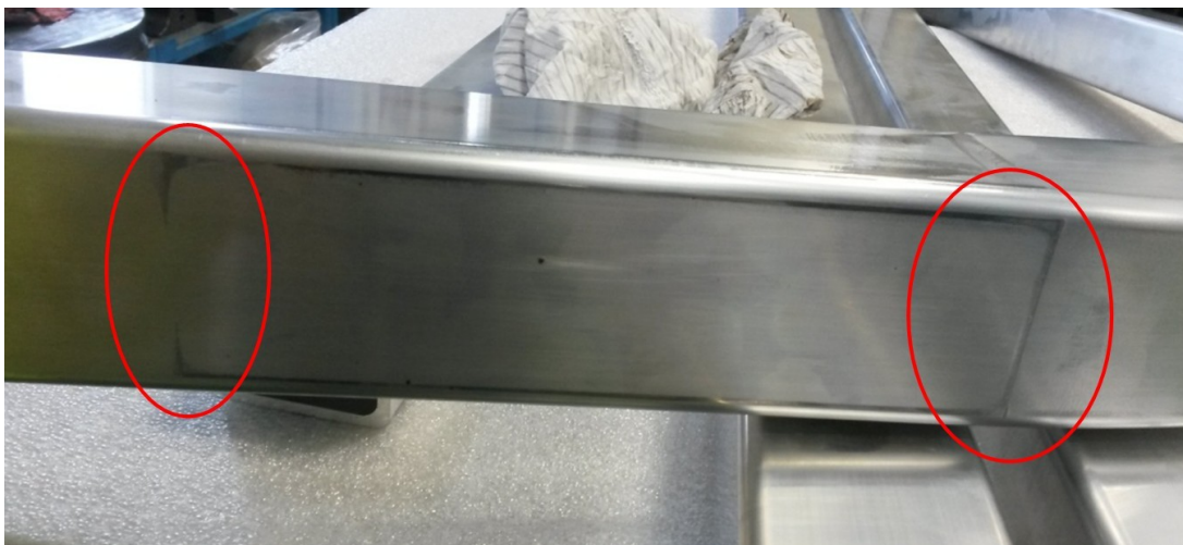
Obrázek 4.2-05: Vada A - otlak na vnější ploše kratší části
