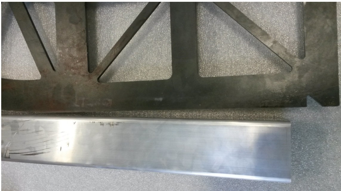
Obrázek 4.2-01: Fotografie kontroly součásti podle šablony
