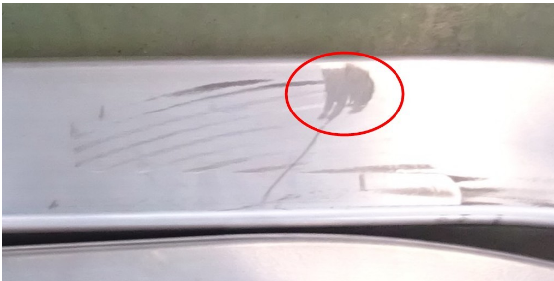
Obrázek 4.2-08: Vada D - vada na spodní ploše kratší části vzorku
