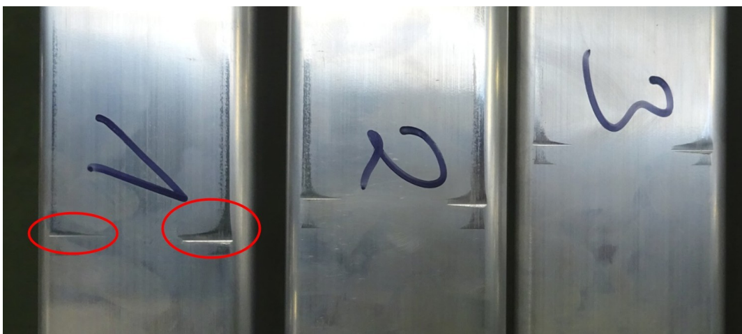
Obrázek 4.2-07: Vada C - otlak na vnější ploše delší části
