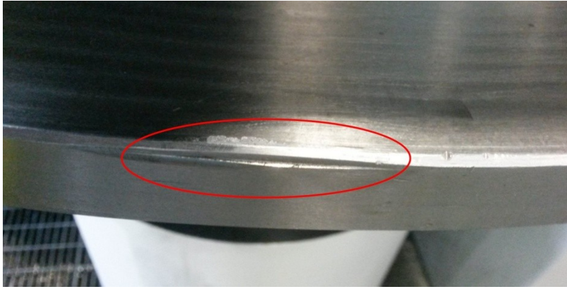
Obrázek 4.3-08: Poškozená hrana na spodní části ohýbacího segmentu
