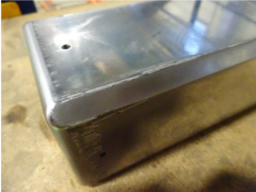
Obrázek 4.2-03: Fotografie trnu po zhotovení prvních třech zkušebních ohybů
