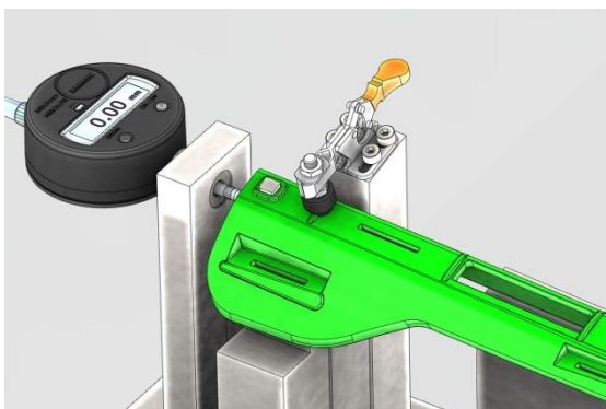
Obr. 48: Jednoúčelový přípravek opatřený mikrometrem pro přesné ustavení součásti [27]
