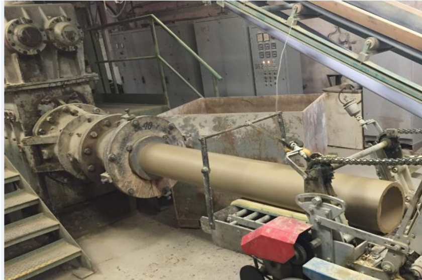
Obrázek č. 12 Vytlačování trubky lisem [11]
