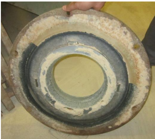
Obrázek č. 13 Vnitřní a vnější koncová část lisu na výrobu trubky
