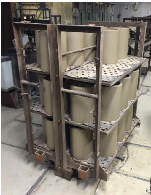
Obrázek č. 18 Komínové vložky připravené k sušení [11]
