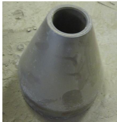
Obrázek č. 13 Vnitřní a vnější koncová část lisu na výrobu trubky
