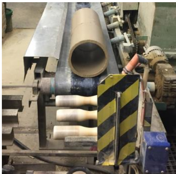
Obrázek č. 16 Přechod trubky na jiný dopravník [11]
