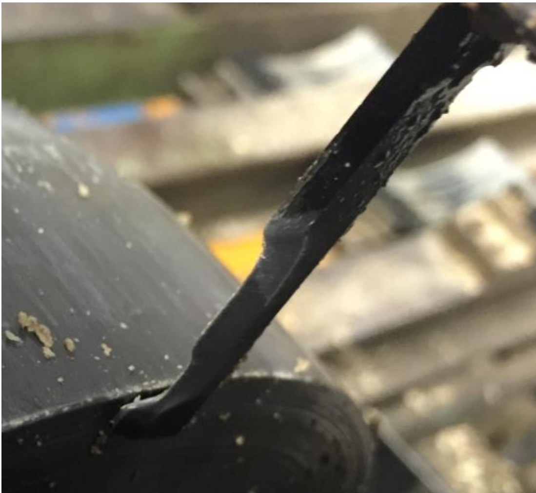
Obrázek č. 8 Opotřeбенý нůž po jedné směně [11]
