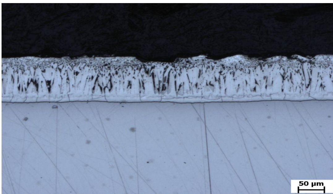
Obr.25: Fotografie metalografického výbrusu broušených vzorků (bez cínu), zvětšeno 100x.
