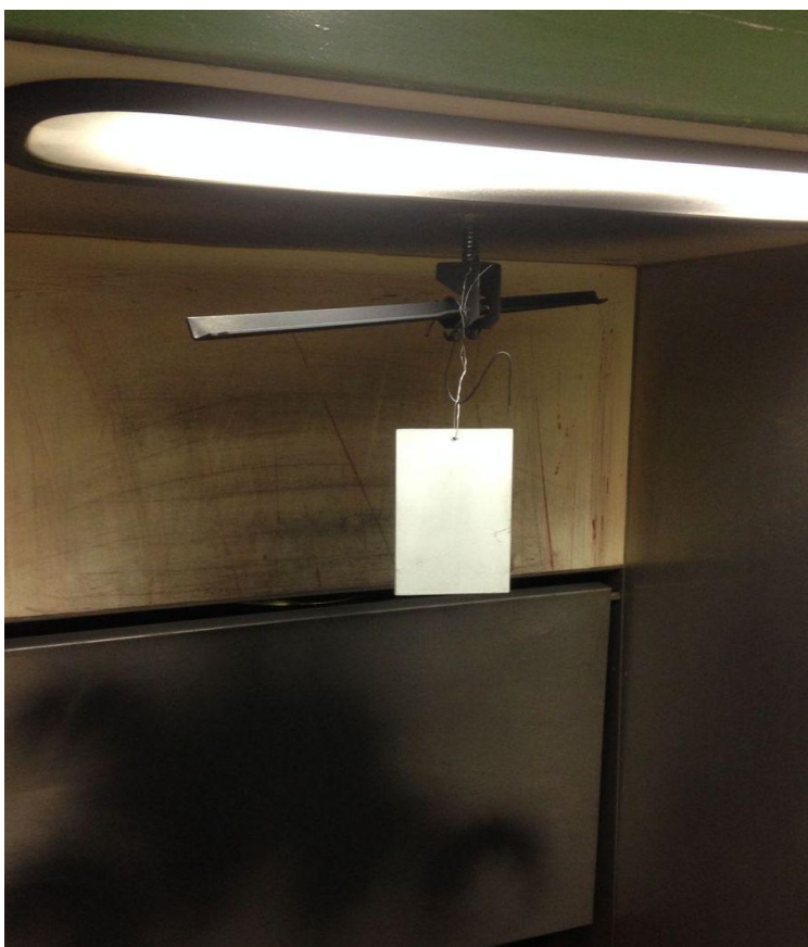
Obr.30: Připravený vzorek na nanesení práškové barvy
