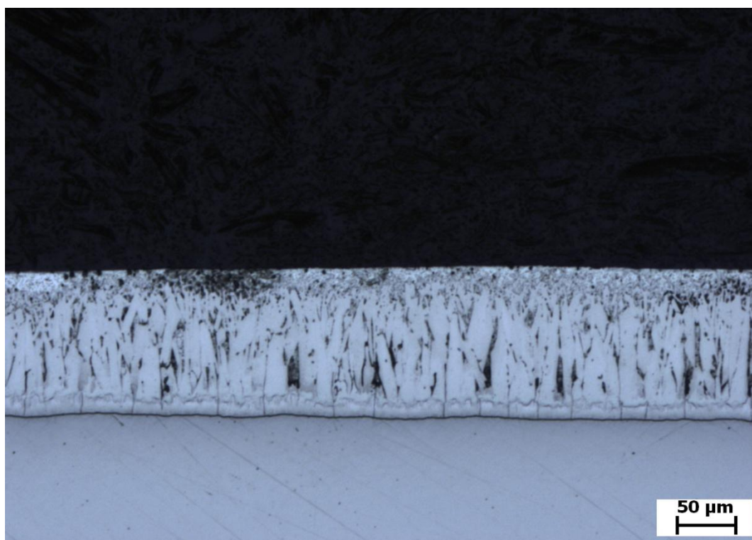
Obr.16: Fotografie metalografického výbrusu vzorků bez úpravy (s cínem), zvětšeno 100x.
