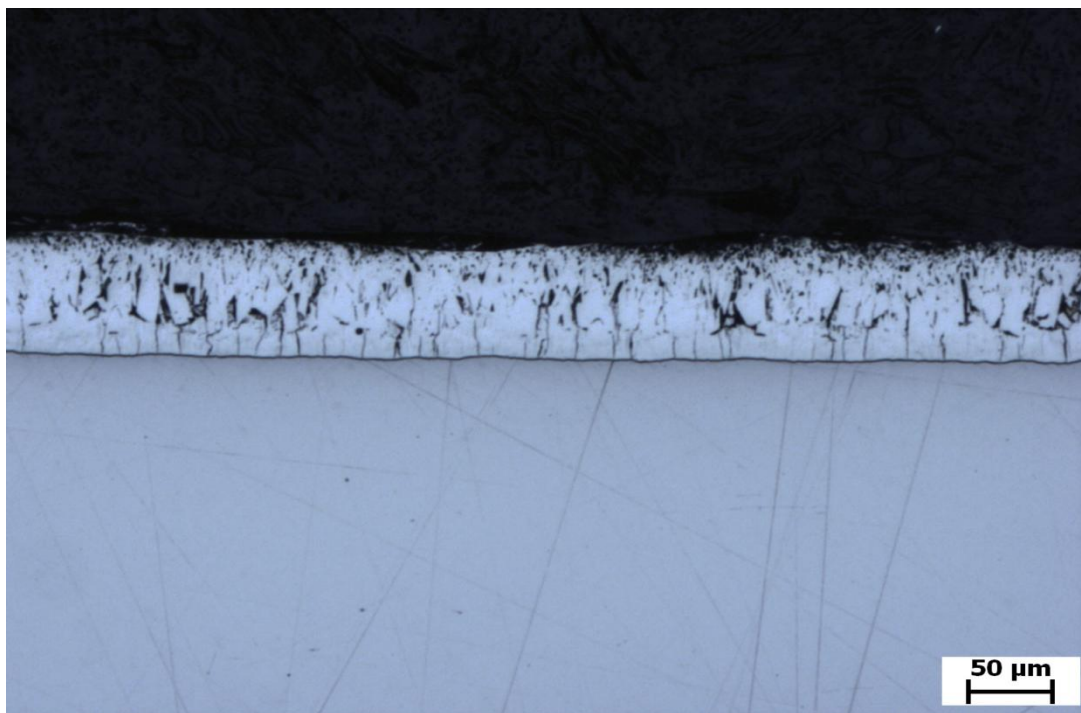
Obr.22: Fotografie metalografického výbrusu broušených vzorků (bez cínu), zvětšeno 100x.
