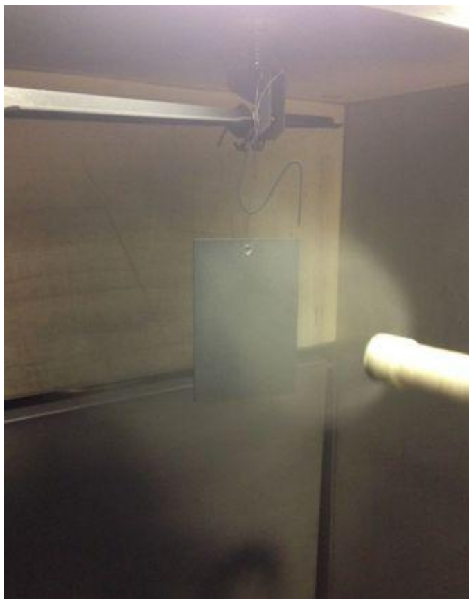
Obr.31: Průběh nanášení práškové barvy na vzorek
