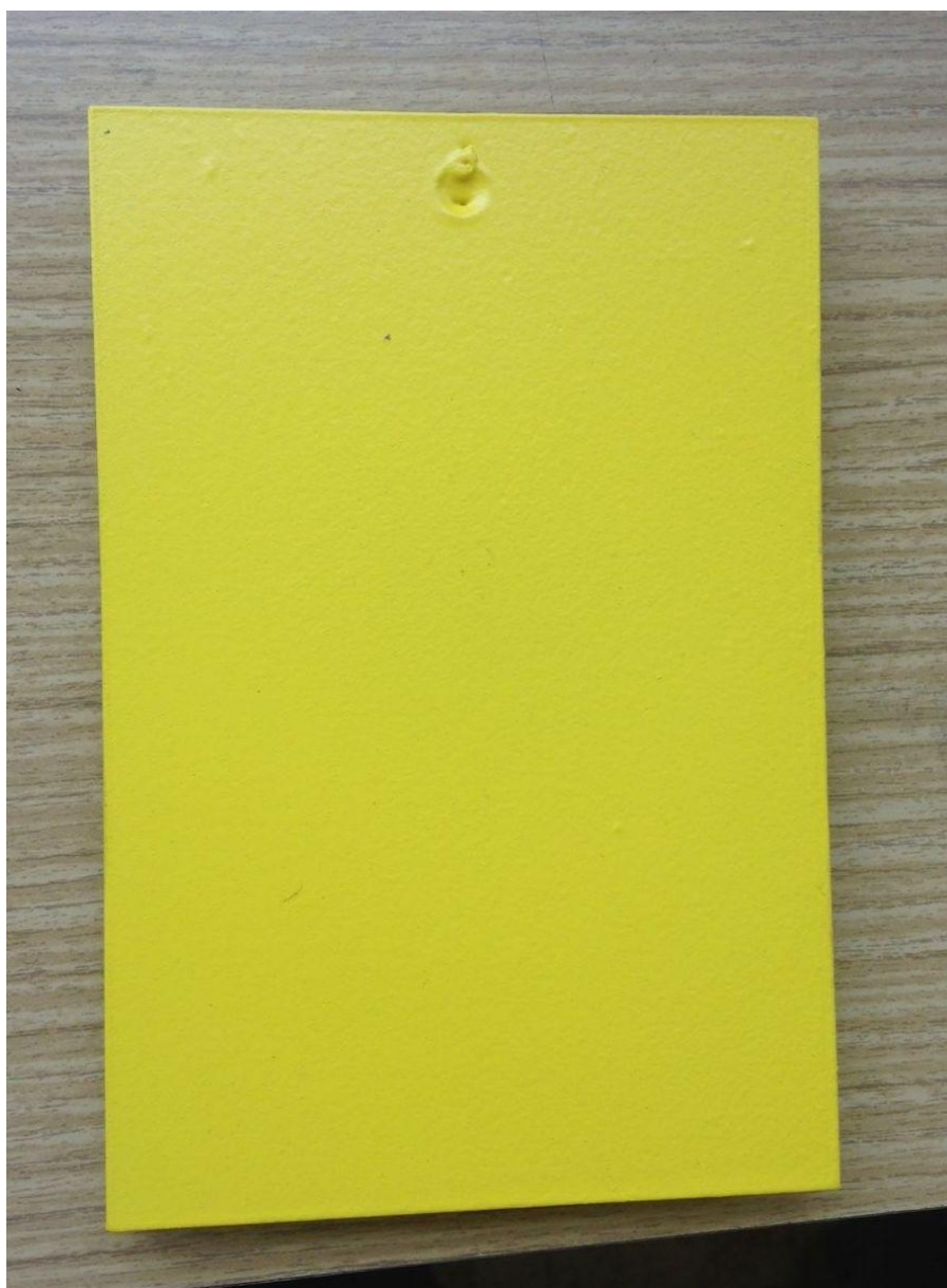
Obr.29: Pozinkovaný vzorek s nanesením vodou-ředitelné NH
