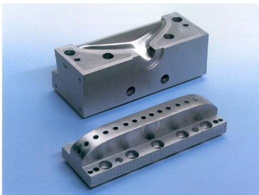
Obr. 5. Součást a její vzhled po PVD pokovení CrN povlakem. [5]
