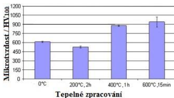
Obr. 15. Mikrotvrdost v závislosti na teplotě a času expozice při vytvrzování. [16,17]
