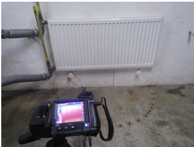
Obr. 6-3 Pohled na snímání teplotního pole termovizní kamerou
