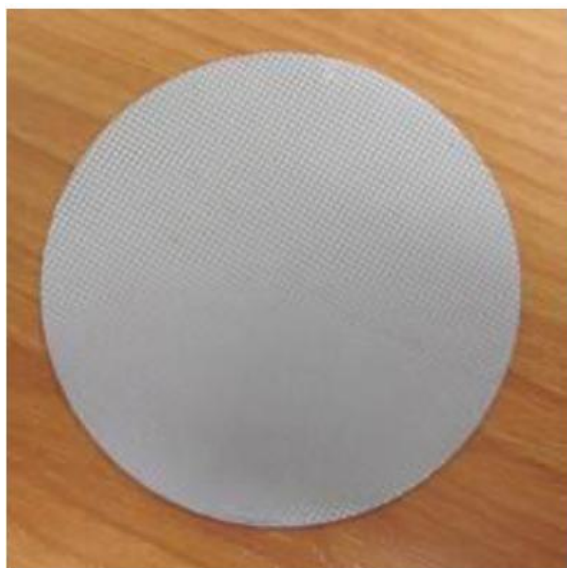
Obrázek 38 Ukázka příkladu nanesené sítě laserem bod o průměru 0,5mm a rozteč 1mm [11]
