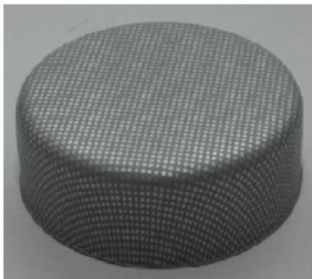
Obrázek 38 Ukázka příkladu nanesené sítě laserem bod o průměru 0,5mm a rozteč 1mm [11]
