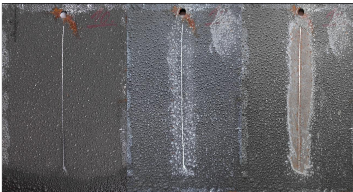
Obr. 31 Konečný stav vzorků s 20%Mg ze solné komory
