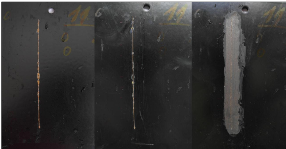
Obr. 34 Konečný stav vzorků s Xylanem 5230 z kondenzační komory
