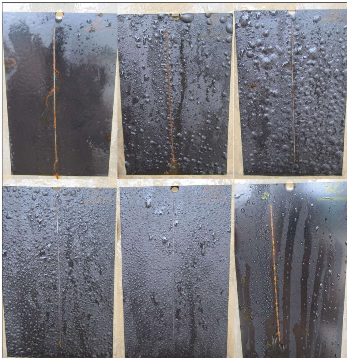
Obr. 16 Vzorok z solné komory po 47,5h
