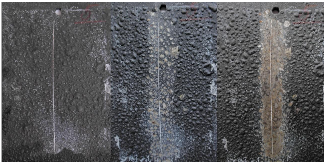
Obr. 24 Konečný stav vzorků s 10%Mg z kondenzační komory
