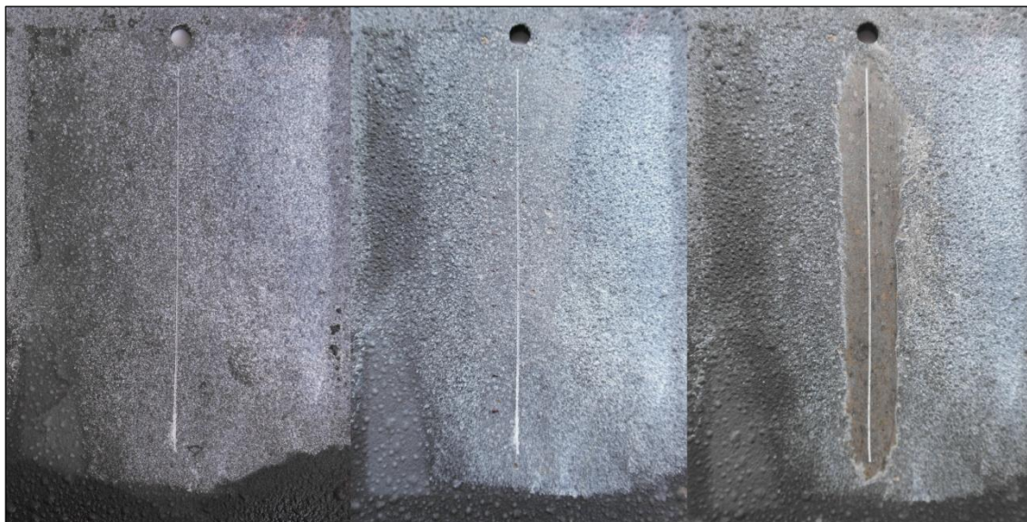
Obr. 30 Konečný stav vzorků s 20%Mg z kondenzační komory
