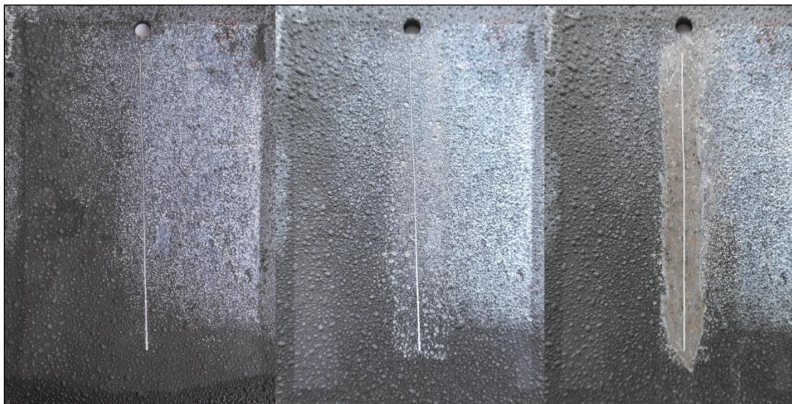
Obr. 28 Konečný stav vzorků s 15%Mg z kondenzační komory
