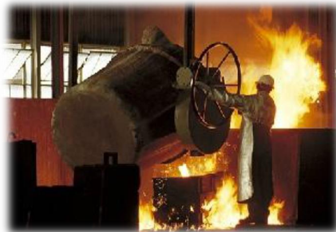
Obr. 12 Plnění formy kovem [8]
