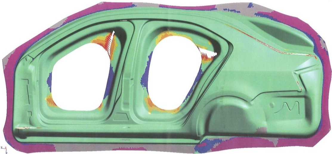
Obr. 6 Výsledek simulace lisovatelnosti postranice z programu AutoForm [9]
