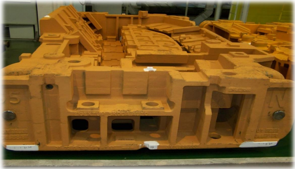
Obr. 14 Hotový surový odlitek spodního dílu [9]
