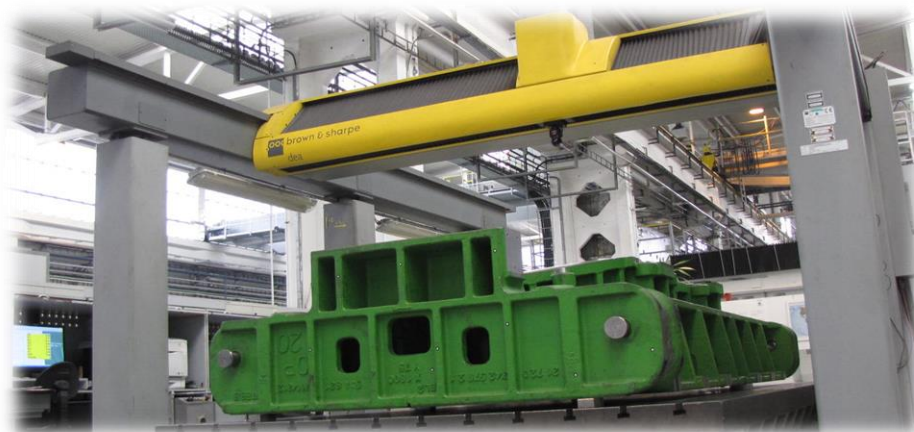
Obr. 36 Měření dotykovou metodou (3D souřadnicový měřicí systém) [11]
