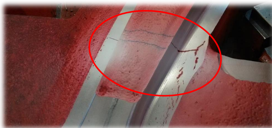
Obr. 37 Vadný odlitek – prasklina [17]
