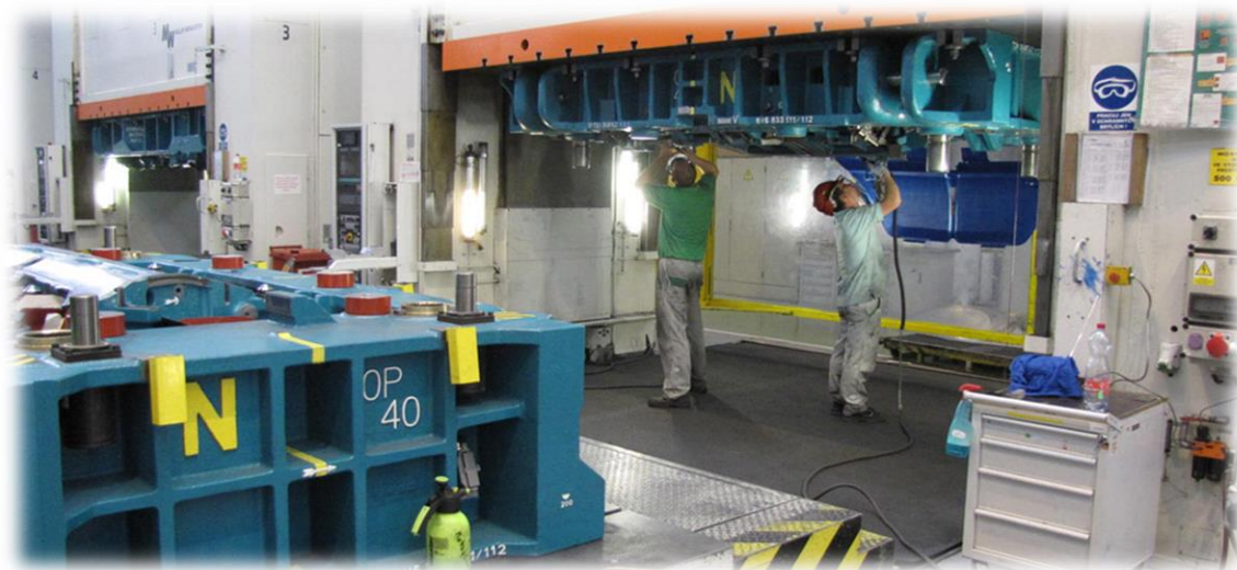
Obr. 23 Zpracování pod slícovacím lisem [11]
