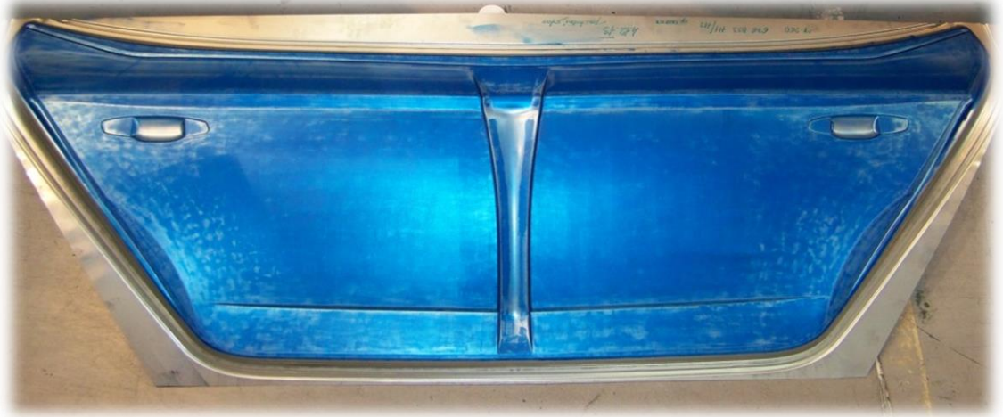
Obr. 24 Vylisek natřený tuširovací barvou [12]
