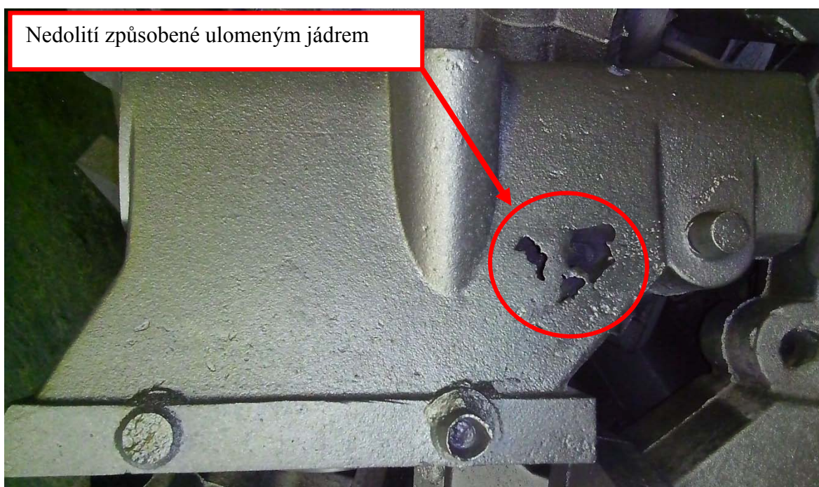
obr. 4-15: Nedolití způsobené ulomeným jádrem
