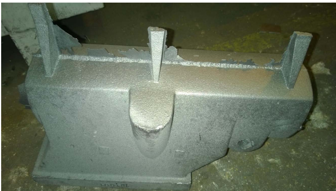
obr. 6-8: Otryskaný odlitek - spodní plocha
