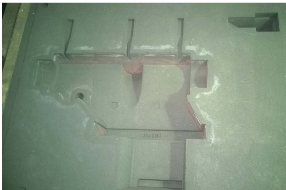
obr. 6-4: Odformovaná spodní část formy
