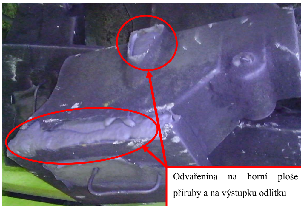
obr. 4-14: Odvařeniny na odlitku 2
