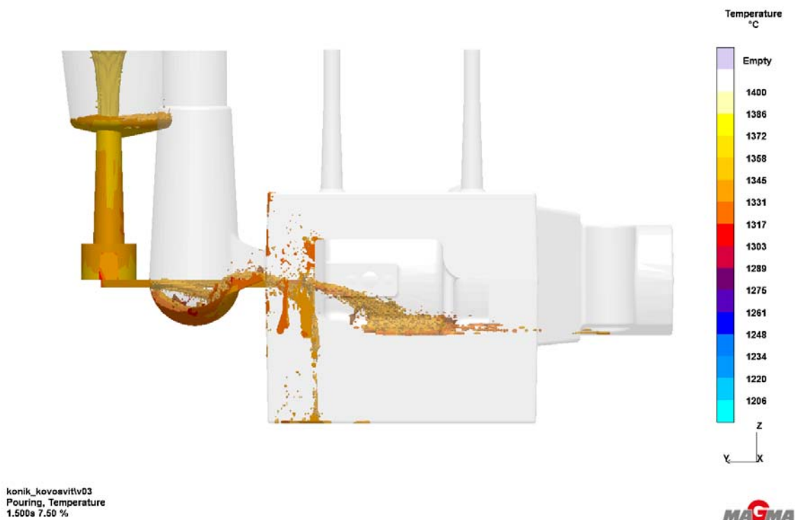
obr. 4-16: Začátek plnění dutiny formy - teplotní pole
