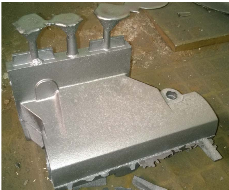
obr. 6-7: Otryskaný odlitek - horní plocha
