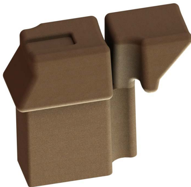
obr. 4-6: Tvarové jádro vnitřní dutiny
