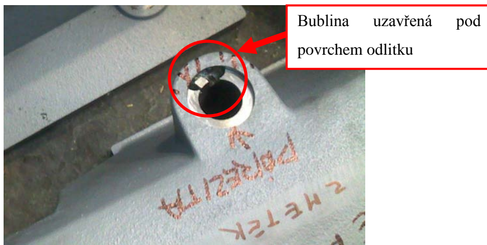
obr. 2-3: Bubliny uzavřené pod povrchem odlitku
