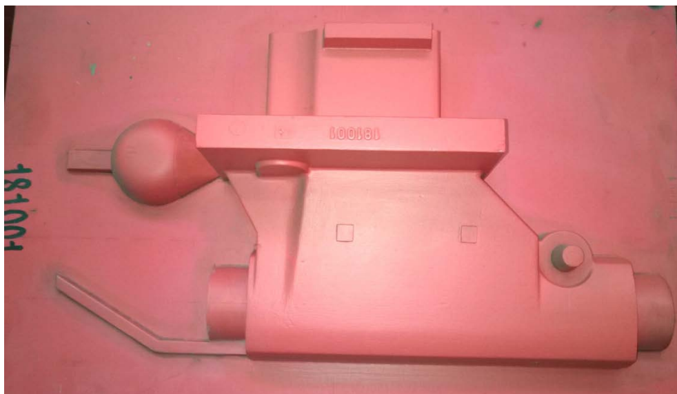
obr. 4-12: Dolní část modelové desky
