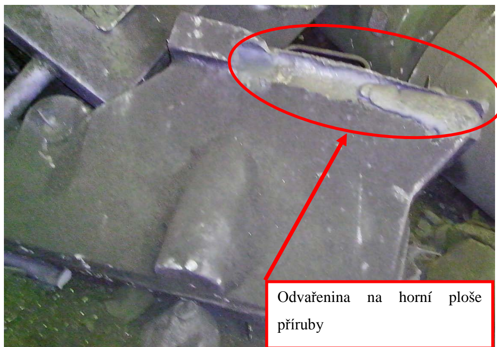
obr. 4-13: Odvařeniny na odlitku 1
