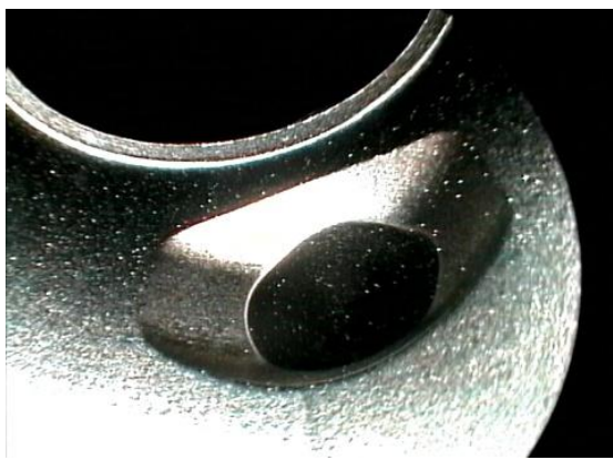
Obrázek 20 - Vyhovující přechody kanálů pozice 5 na výstupní kontrole. Bez lokálního zafrézování vlevo, s lokálním zafrézováním vpravo. Stav po výsledné kontrole. [2]
