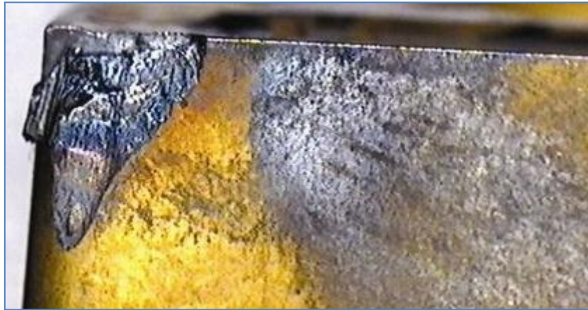
Obrázek 47 - Opotřebení břitu křehkým lomem [5]
