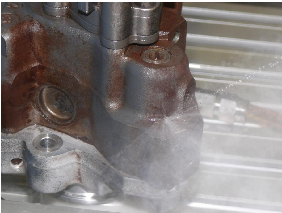
Obrázek 21 - Únik paliva trhlinou ve stěně tělesa [2]
