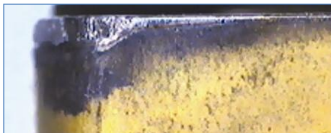
Obrázek 40 – Opotřebení hřbetní plochy nástroje otěrem [5]
