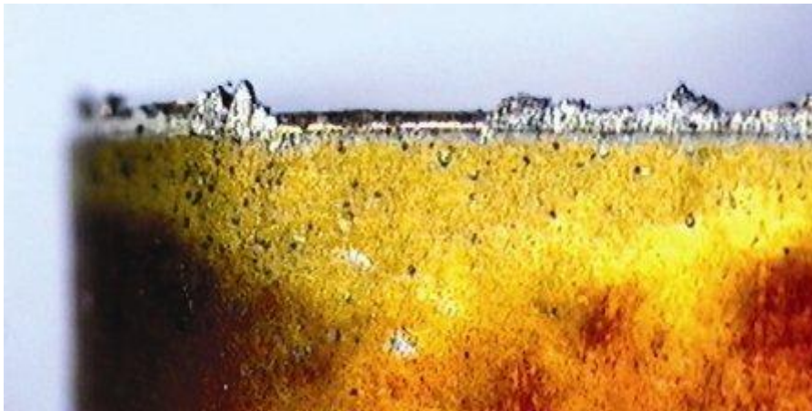
Obrázek 29 - Nárůstek na nástroji
