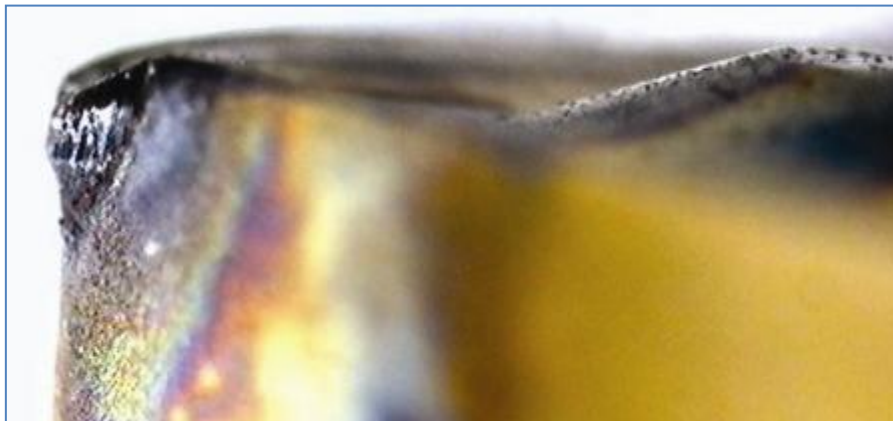
Obrázek 43 – Plastická deformace břitu [5]
