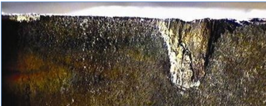
Obrázek 46 - Poškození neřezné části nástroje působením třísky [5]
