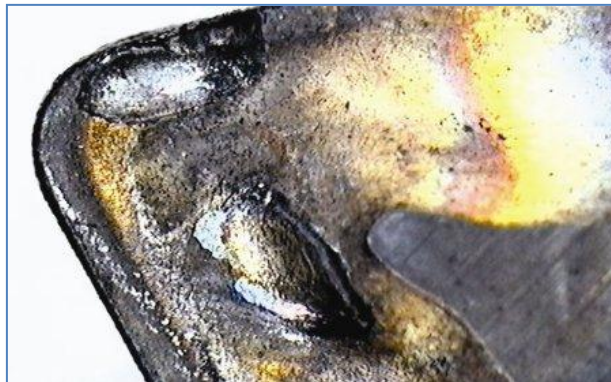
Obrázek 41 - Výmol na čelní ploše VBD [5]
