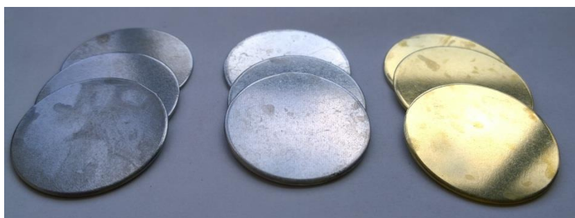
Obr. 48 Omílání v Pragopol 550, 120 minut
