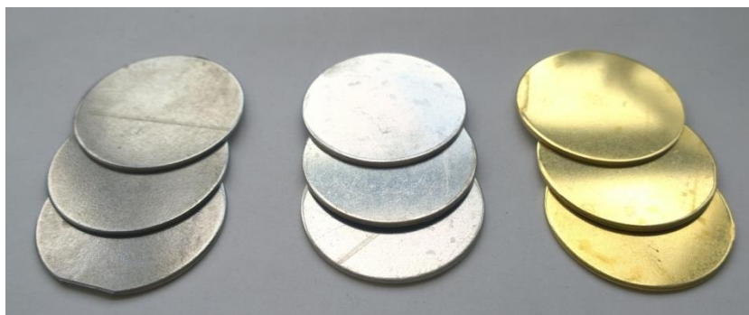
Obr. 47 Omílání v Pragopol 550, 60 minut
