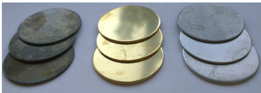
Obr. 43 Omílání v Pragopol 812, 30 minut
