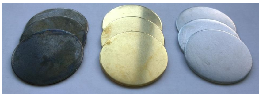
Obr. 44 Omílání v Pragopol 812, 60 minut
