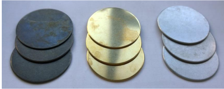
Obr. 45 Omílání v Pragopol 812, 120 minut
