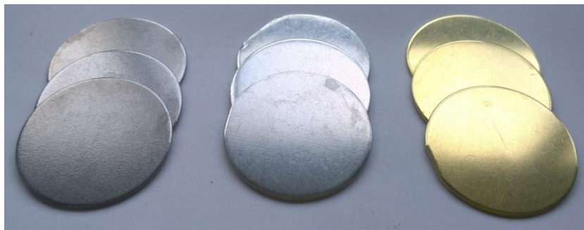
Obr. 46 Omílání v Pragopol 550, 30 minut
