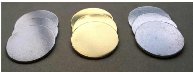
Obr. 42 Omílání v Pragopol 809, 120 minut
