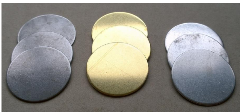
Obr. 40 Omílání v Pragopol 809, 30 minut
