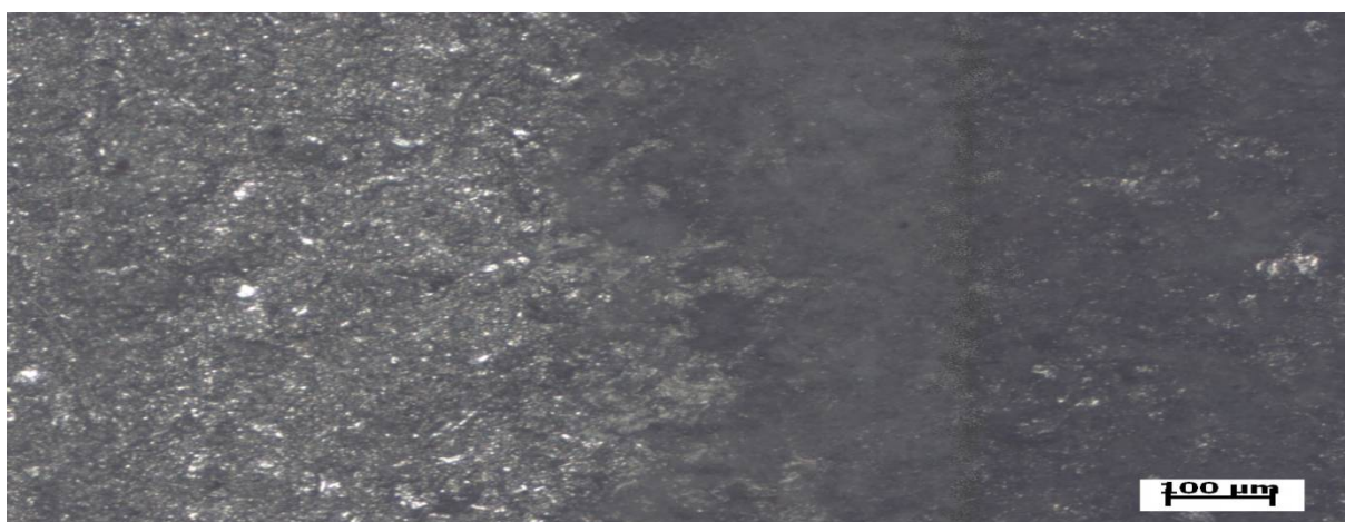
Obr. č. 31. Přejímová oblast louhování 180 minut v 15% NaOH
