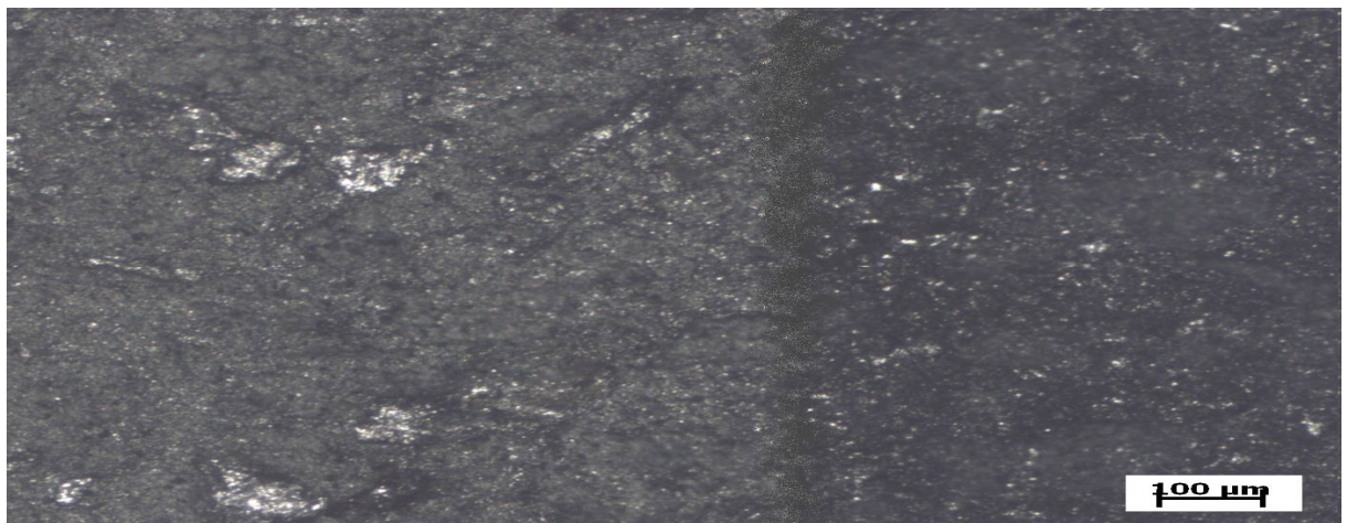
Obr. č. 19. Metalografický snímek přechodové oblasti u technologie tryskání
