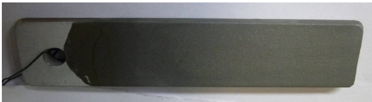
Obr. č. 32. Vzorek po louhování 60 minut ve 30% NaOH
