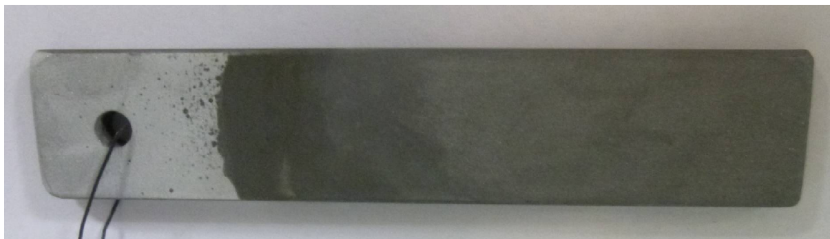
Obr. č. 28. Vzorek po louhování 120 minut v 15% NaOH
