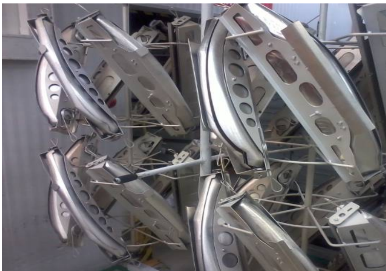
Obr. č. 38. Příklad členitosti planetových držáků
