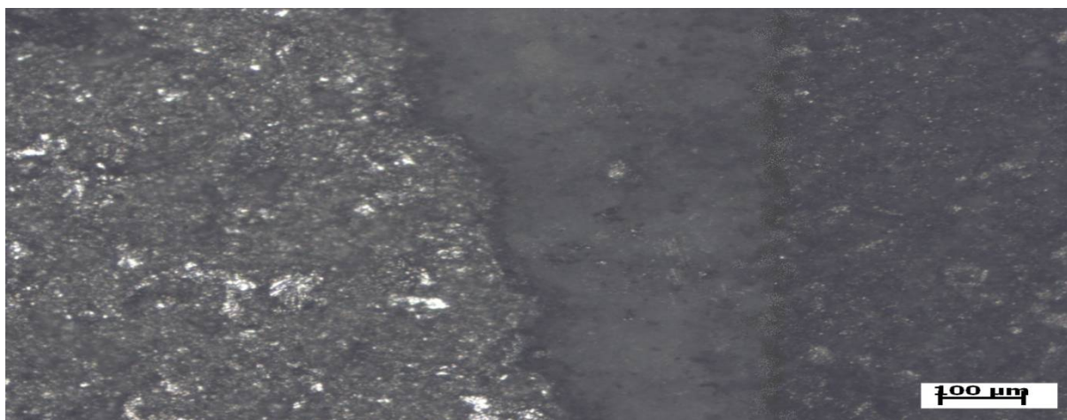
Obr. č. 29. Přechodová oblast louhování 120 minut v 15% NaOH
