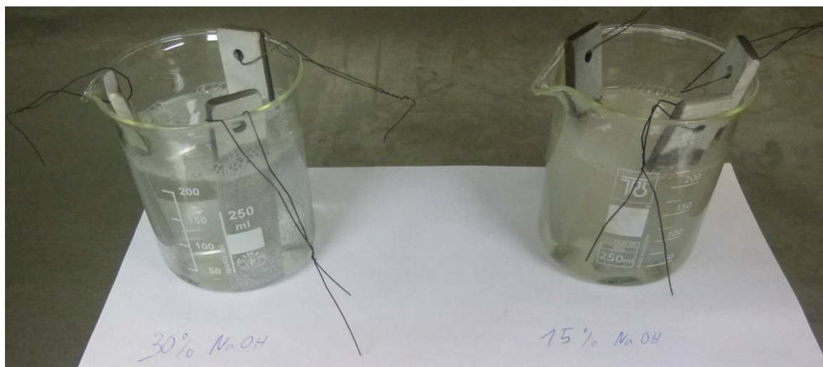
Obr. č. 24. Louhovací lázně s 30% NaOH a 15% NaOH
