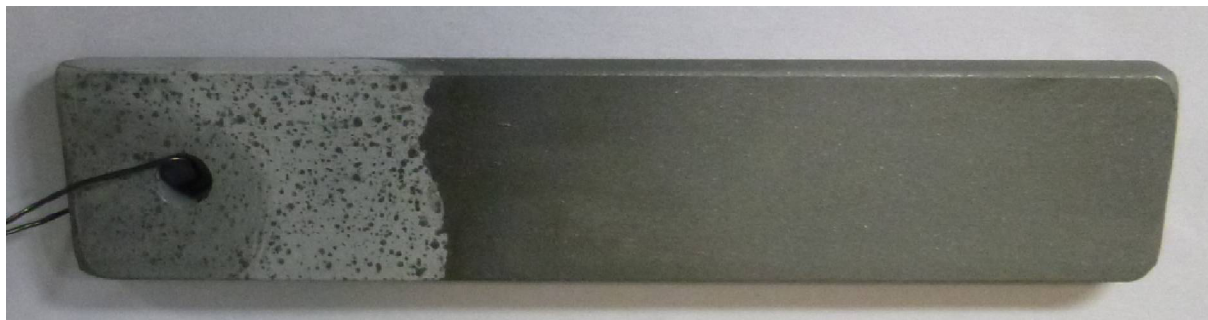
Obr. č. 30. Vzorek po louhování 180 minut v 15% NaOH
