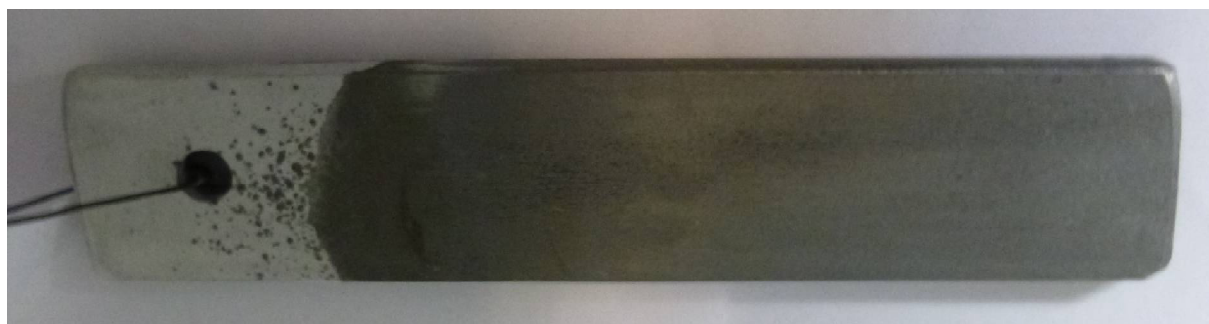
Obr. č. 26. Vzorek po louhování 60 minut v 15% NaOH
