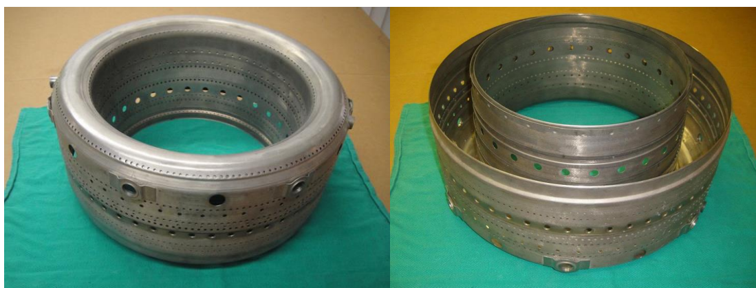
Obrázek 8 příklad plechového dílu – část spalovací komor 3 [4]
