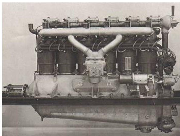
Obrázek 1 Licenční letadlový motor vyrobený r.1923 v továrně WALTER: BMW 240 k. [7]
