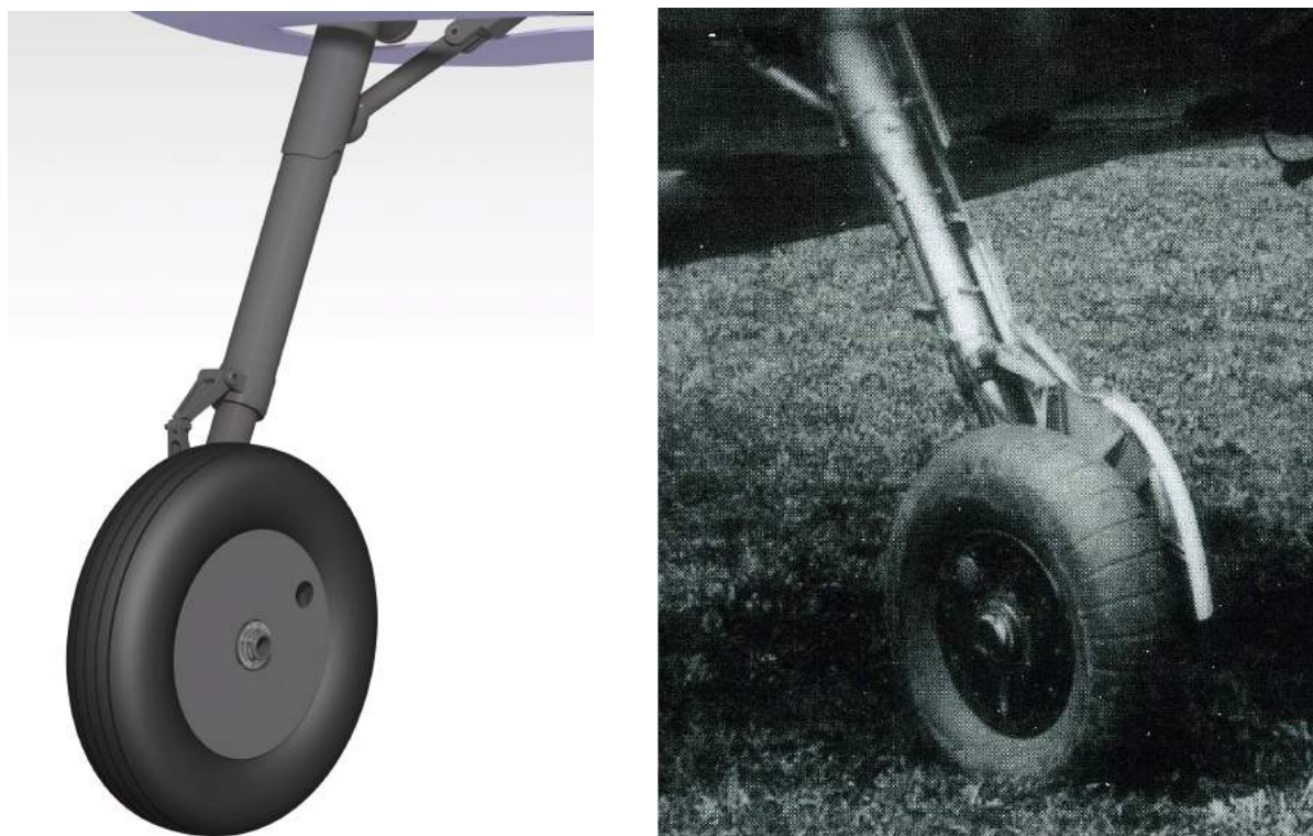
Obr. 7.11: Srovnání pneumatiky a ráfku hlavního podvozku pro repliku s původním typem [3]
