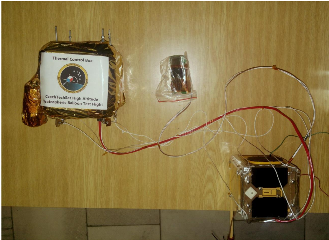
Obr. 24 – Sestava CubeSatu, externí radiostanice, termoboxu a kamery
