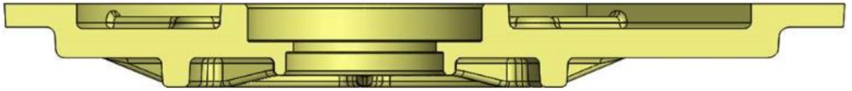
Obr. 31 Zadní díl var. 2 – řez ložiskem
