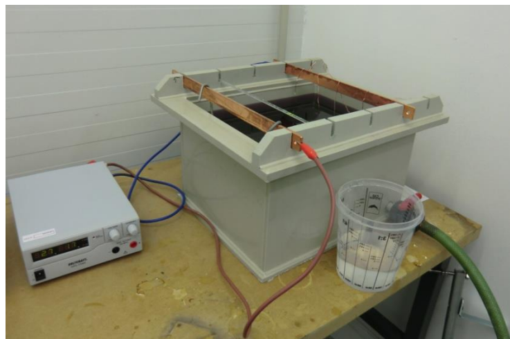
Obrázek 14 Pracoviště pro pokovení zkušebních vzorků s povlakem ZnNi
