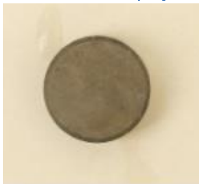
Obrázek 30 Vzorek: Povlak o tloušťce 8 \mu\text{m} po 72 h v korozní komoře
