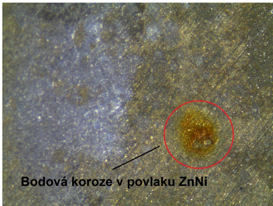
Obrázek 39 Zobrazení povrchu po odstranění korozních zplodin - doba expozice 451 h v korozní komoře – detail bodové koroze v povlaku
