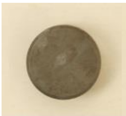
Obrázek 26 Povlak o tloušťce 5 \mu\text{m} po 238 h v korozní komoře
