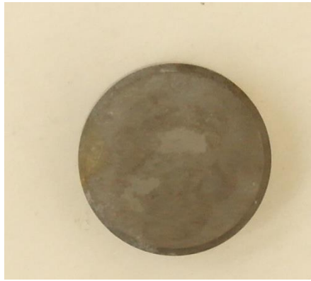
Obrázek 36 Povlak o tloušťce 13 \mu\text{m} po 238 h v korozní komoře
