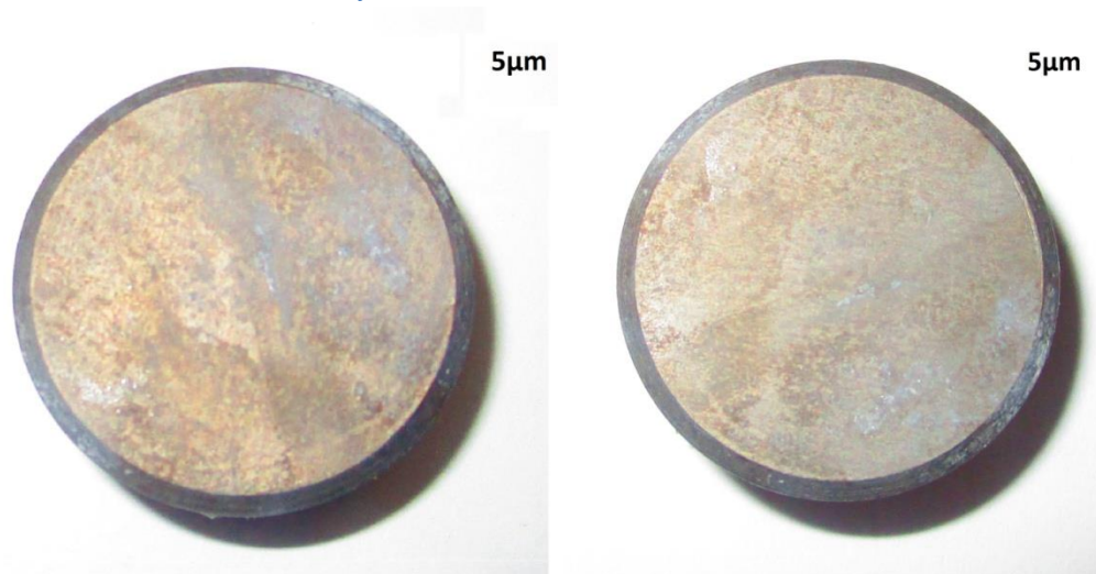
Obrázek 25 Povlak o tloušťce 5 \mu\text{m} po 72 h v korozní komoře
