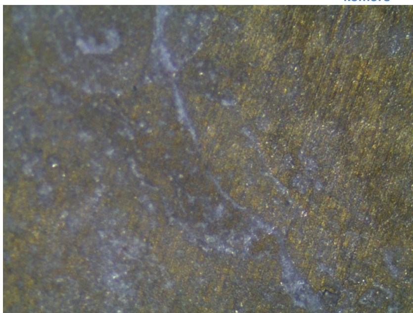
Obrázek 27 Povlak před odstraněním korozních zplodin - 451 h v korozní komoře
