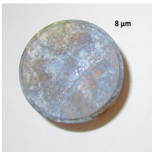
Obrázek 32 Povlak před odstraněním korozních zplodin - 451 h v korozní komoře
