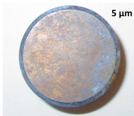
Obrázek 28 Povlak po odstranění korozních zplodin - 451 h v korozní komoře
