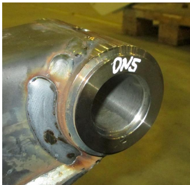
Obrázek 59. Vizuelní kontrola svarového spoje návarku 0N5
