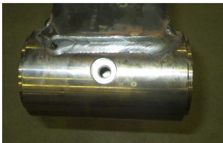
Obrázek 60. Vizuelní kontrola svarového spoje návarku 0N5
