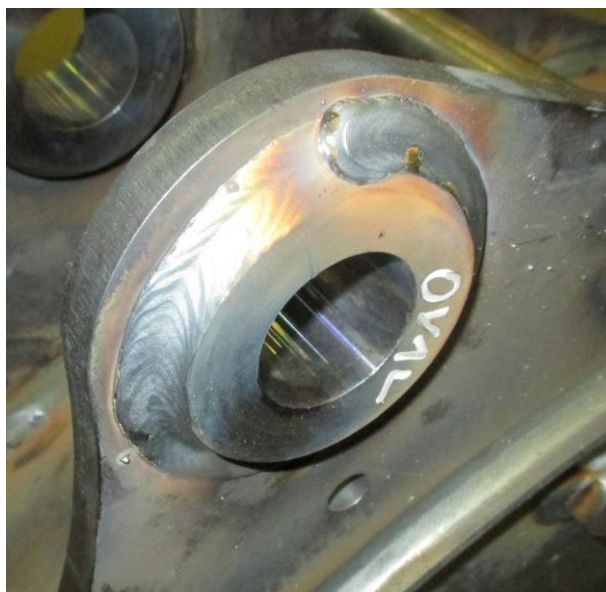
Obrázek 35. Vizuální kontrola svarového spoje návarku 0V11
