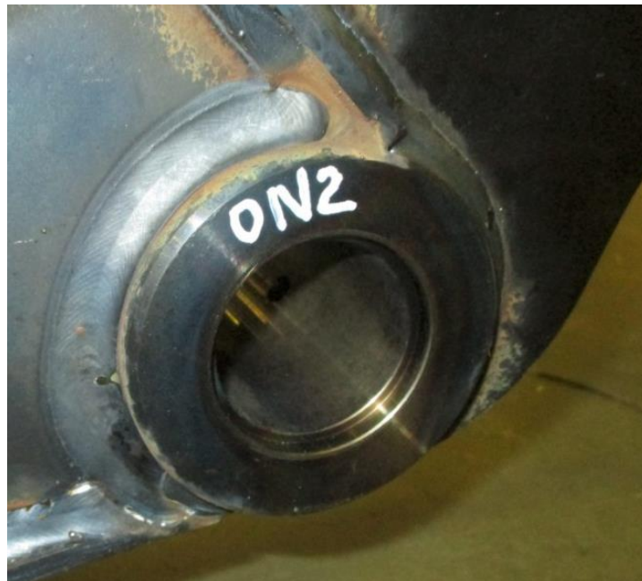
Obrázek 54. Vizualní kontrola svarového spoje návarku 0N2
