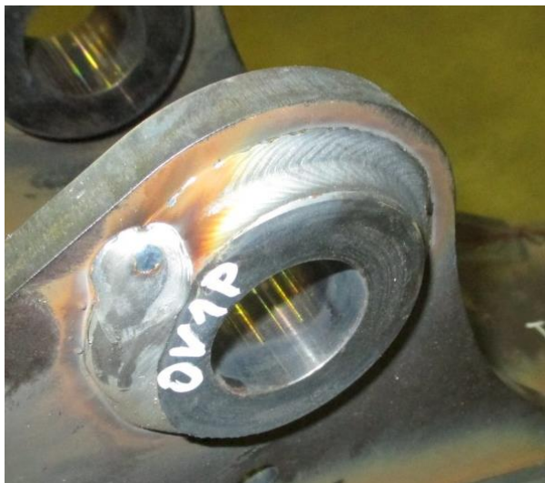
Obrázek 36. Vizuální kontrola svarového spoje návarku 0VIP
