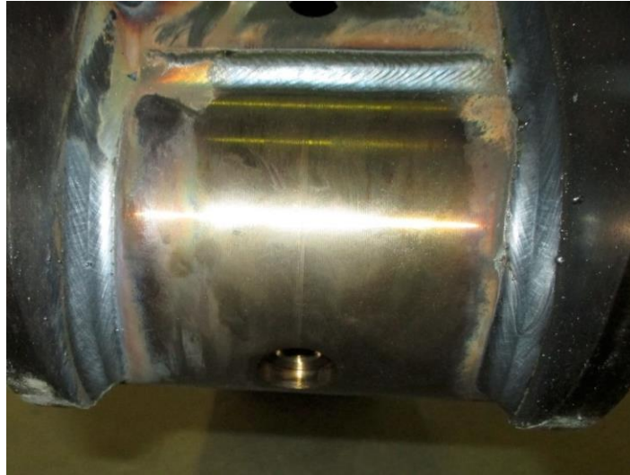
Obrázek 53. Vizualní kontrola svarového spoje návarku 0N2
