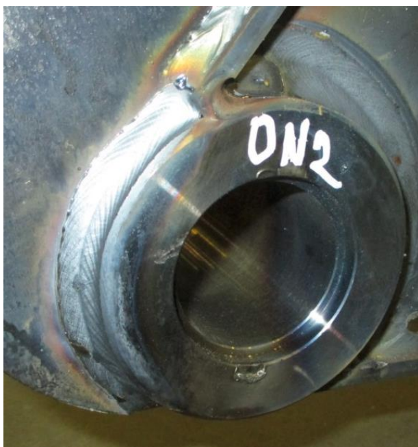
Obrázek 52. Vizuální kontrola svarového spoje návarku 0N2
