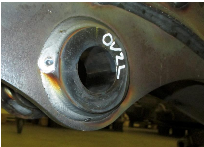
Obrázek 38. Vizuální kontrola svarového spoje návarku 0V2L
