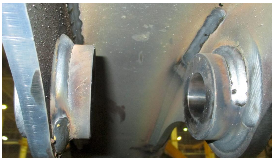
Obrázek 39. Vizuální kontrola svarového spoje návarku 0V12 a 0V2P
