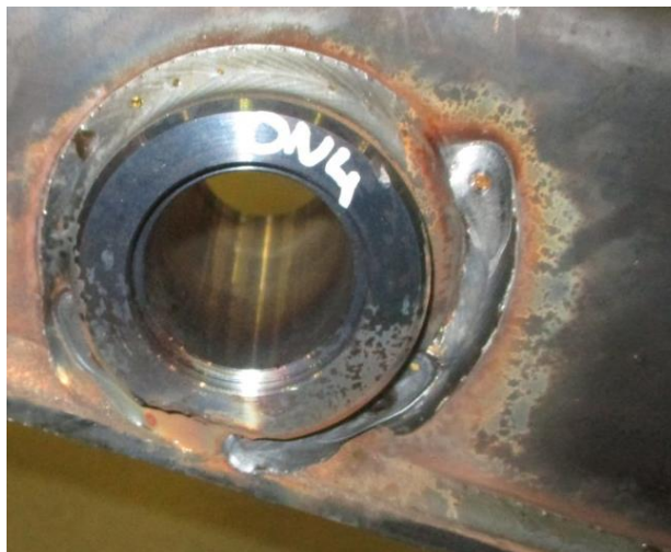
Obrázek 58. Vizuelní kontrola svarového spoje návarku 0N4
