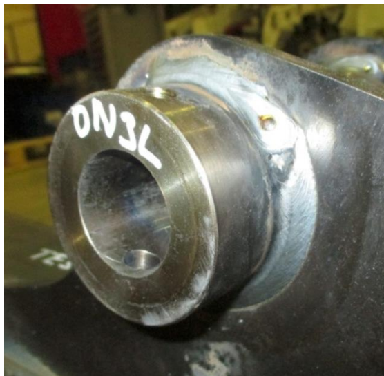
Obrázek 55. Vizuální kontrola svarového spoje návarku 0N3L
