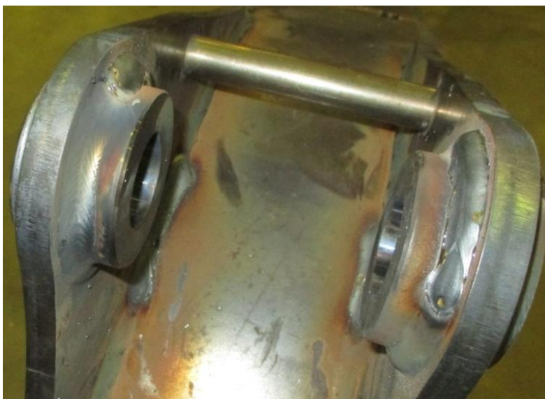
Obrázek 37. Vizuální kontrola svarového spoje návarku 0V1L a 0VIP
