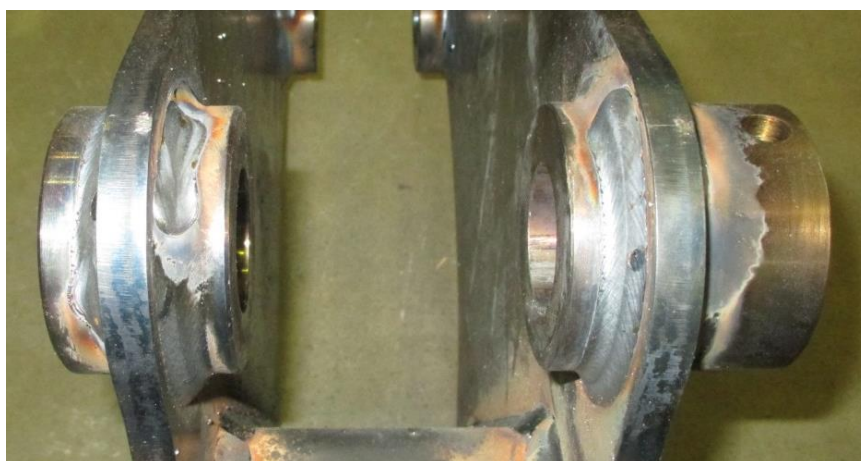
Obrázek 56. Vizuální kontrola svarového spoje návarku 0N3L a 0N3P
