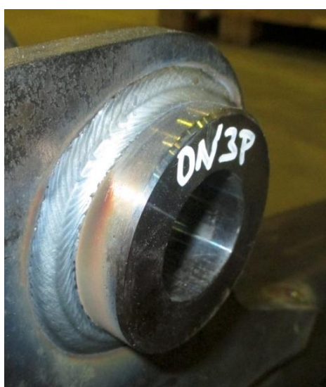
Obrázek 57. Vizuální kontrola svarového spoje návarku 0N3P
