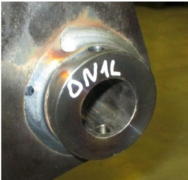
Obrázek 51. Vizuální kontrola svarového spoje návarku 0N1L
