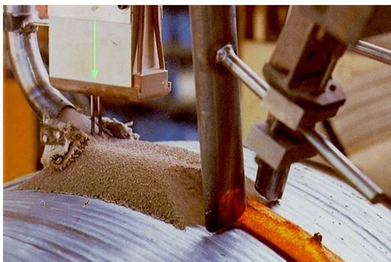
Obrázek 7. Technologie svařování pod tavidlem [3]
