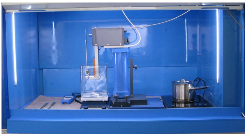
Obr. 47 Zařízení pro měření zbytkových napětí metodou elektrolytického odleptávání
