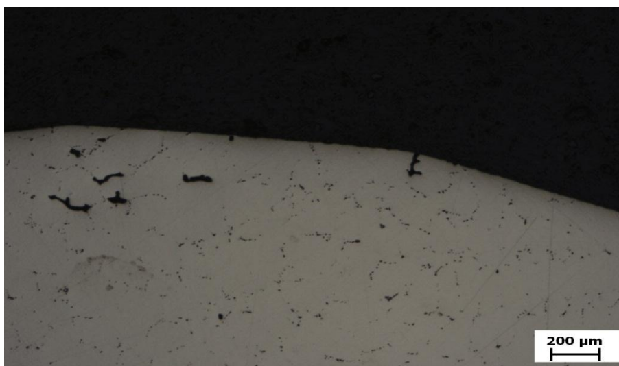
Obr. 37 Lopatka č. 3, metalografický vzorek, zvětšení 25x
