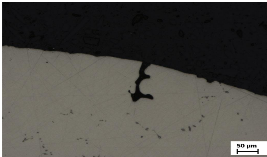
Obr. 38 Lopatka č. 3, metalografický vzorek, zvětšení 100x
