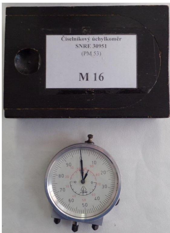
Obr. 8.7 Tříbodový dotykový indikátor (s přesností měření \pm 0,005 \text{ mm} )
