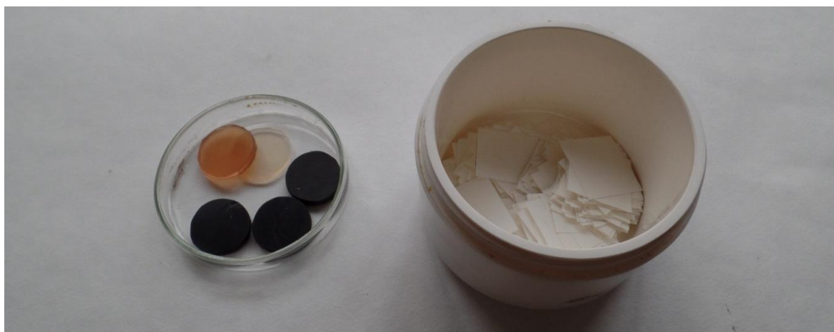
Obr. 8.3 Pryžové kotoučky (o tloušťce 5 \pm 0,5 mm a tvrdosti 50 \pm 5 IRHD) a papírky (zhotovené z běžného kancelářského papíru o plošné hmotnosti 60 – 80 \text{g}/\text{m}^2 )
