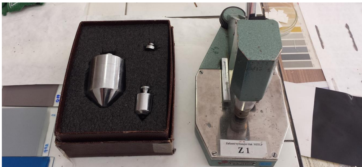
Obr. 8.4 Závaží o hmotnosti 20 g, 200 g, 2 kg a zařízení vyvozující zatížení 20 kg
