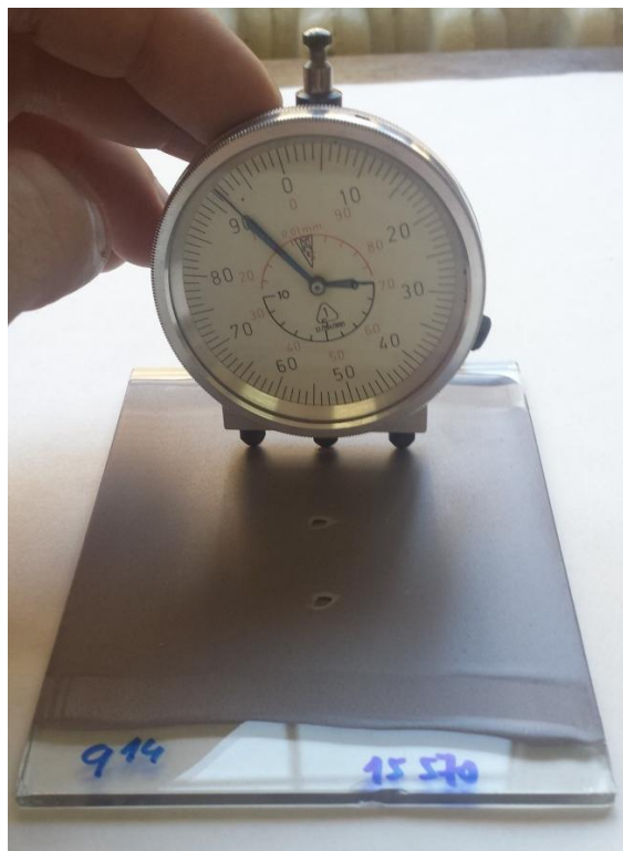
Obr. 8.7 Tříbodový dotykový indikátor (s přesností měření \pm 0,005 \text{ mm} )
