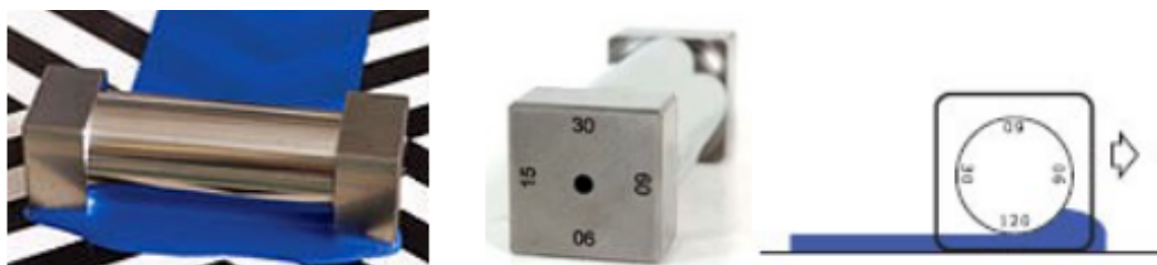
Obr. 5 - Nanášecí pravítko Baker (vlevo), jednotlivé velikosti štěrbin v \mu\text{m} (uprostřed), princip aplikace (vpravo)[30]
