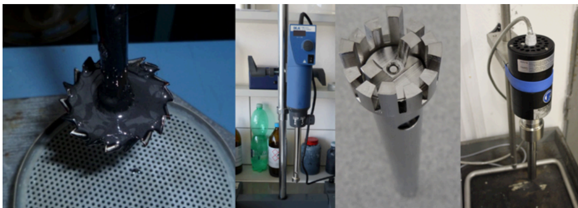
Obr. 15 - Použité dispergátory: zubové míchadlo (vlevo), rotor – stator (uprostřed), ultrazvukový homogenizátor (vpravo)
