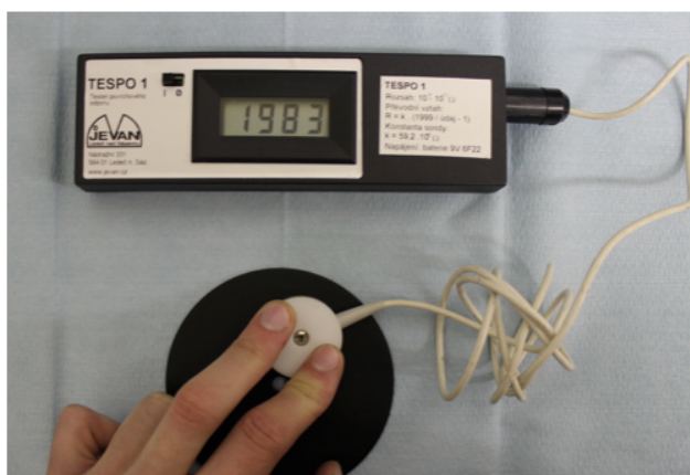
Obr. 23 - Měření vnitřního elektrického odporu zařízením TESPO 1
