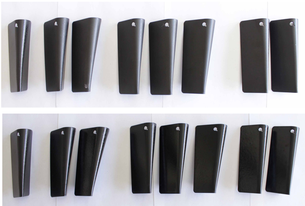
Obr. 38 - Vzorky po ohybové zkoušce – s příměsí grafitu (nahore), s příměsí MWCNT (dole)
