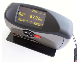
Obr. 21 - Stanovení zrcadlového lesku pod úhlem 60° na povlaku MWCNT SRVZ3
