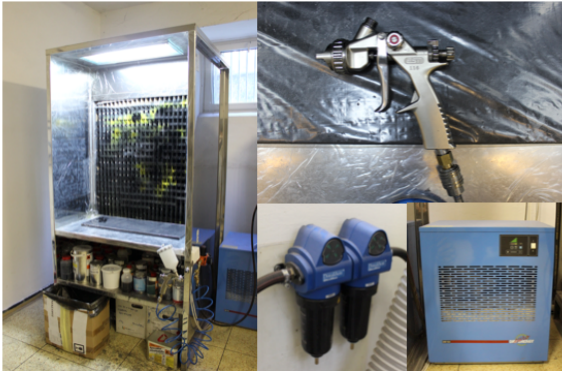
Obr. 16 - Lakovací box (vlevo), stříkací pistole EST+ 116 (vpravo nahoře), dvoustupňový filtr Donaldsen (uprostřed), vymrazovací box MTA Dry Energy DE103 (vpravo dole)
