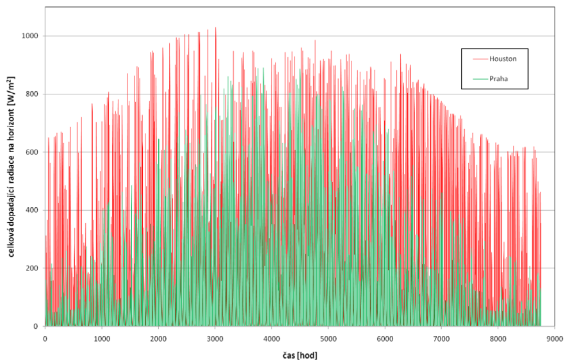
Obr. 2.6 - Průběh celkové dopadající radiace na horizontální rovinu během roku
