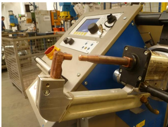
Obr. 42 Svařovací odporový lis MIDIspot (vlevo) a geometrie elektrodové čepičky (vpravo)
