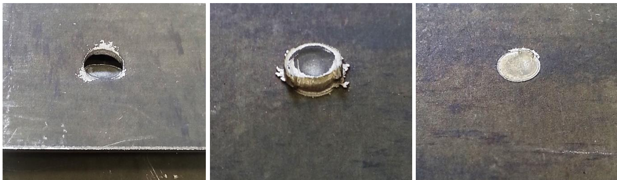
Obr. 53 Možné varianty porušení svarů po zkoušce stříhem ukázané na svaru T5113 (vlevo), T5117 (uprostřed) a T5114 (vpravo)
