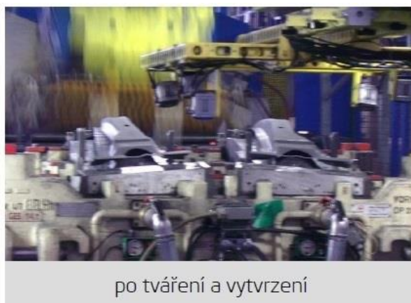
Obr. 29 Výroba za tepla tvářených dílů přímou metodou lisování ve ŠKODA AUTO [15]
