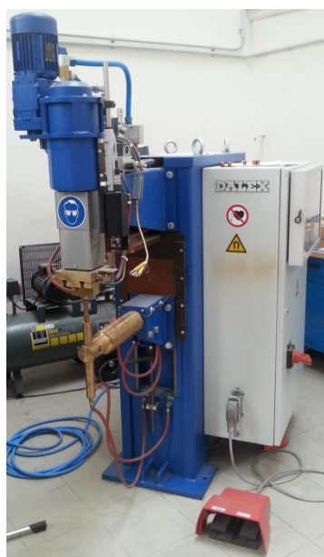
Obr. 43 Svařovací odporový lis PMS 11-4 (vlevo) a geometrie elektrodové čepičky (vpravo)
