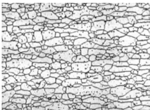
Obr. 18 Typická mikrostruktura oceli HSLA 340 (HC340LA) [24]
