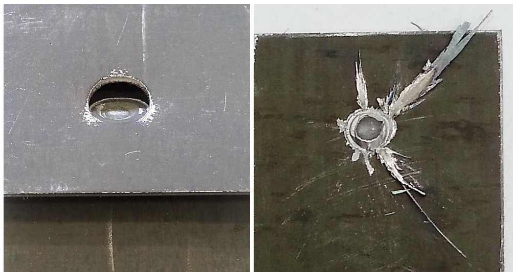
Obr. 55 Možné varianty porušení svarů po zkoušce stříhem ukázané na svaru T2217 (vlevo) a T1212 (vpravo)
