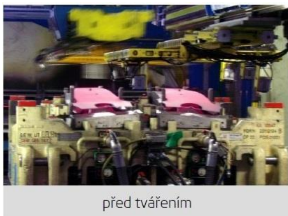
Obr. 29 Výroba za tepla tvářených dílů přímou metodou lisování ve ŠKODA AUTO [15]
