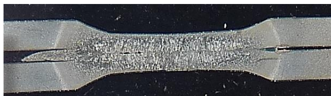
Obr. 54 Metalografický výbrus svaru T621 s výronkem a velkou hloubkou vtisků po elektrodách
