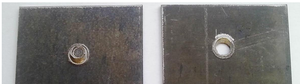
Obr. 50 Vytržená část svaru M26 (vlevo) a otvor po vytržené části svaru (vpravo)
