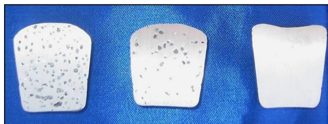
Obr. 22 Porovnání vzorků, naplyněných (vlevo a uprostřed), odplyněných (vpravo) [18]
