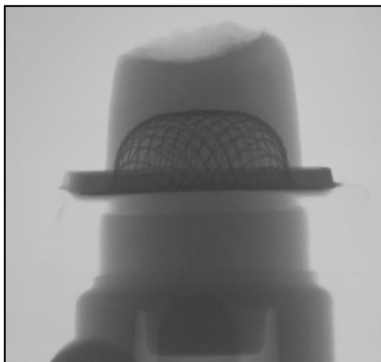
Obr. 11 Obrázek rentgenu odlitku s Fe sítkem umístěným ve vtoku [18]
