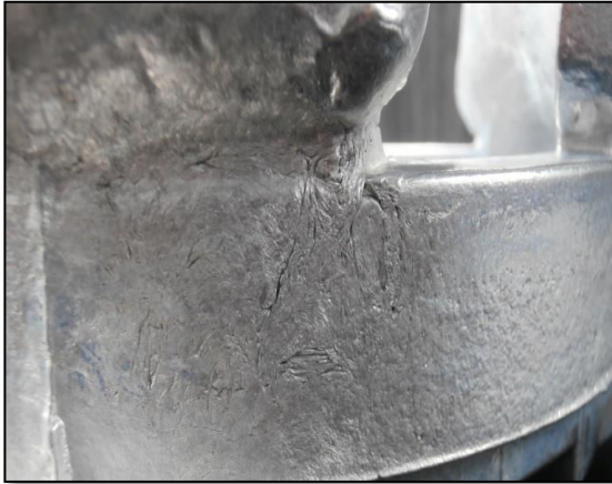
Obr. 5 Oxidická blána v přechodové oblasti
