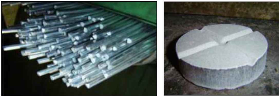
Obr. 16 Očkovací tyče a modifikační tableta
