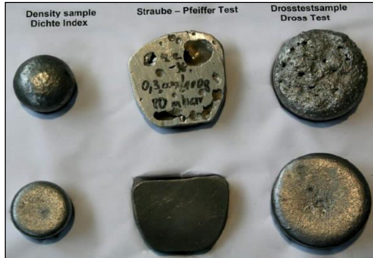
Obr. 24 Vzorky získané ze zkoušky DI, Straube – Pfeiffer Test a Dross Test [18]
