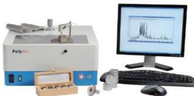
Obr. 27 Jiskrový emisní optický spektrometr OES PolySpek [23]
