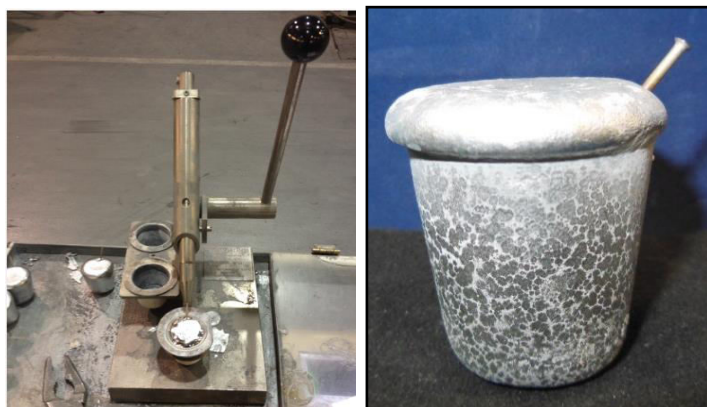
Obr. 30 Zařízení TA 110 pro termickou analýzu a vzorek s ochrannou trubičkou NiCr-Ni
