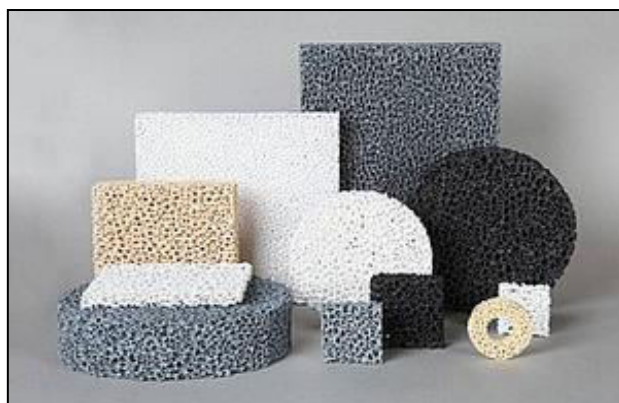
Obr. 12 Ukázka pěnových filtrů pro slitiny neželezných kovů [14]
