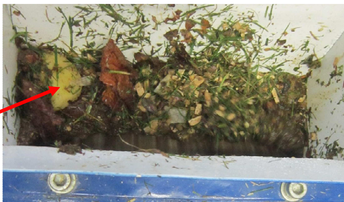
Obr. 4.21 Větší kusy materiálu v násypce přeskakují
