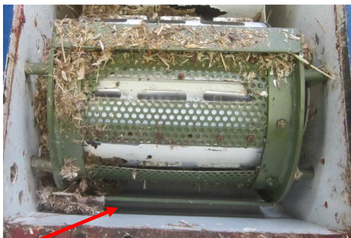
Obr. 4.22 Úzký prostor za výstupním otvorem z mlecí části
