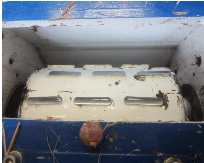
Obr. 4.6 Macerační mlýn konfigurace bez síta
