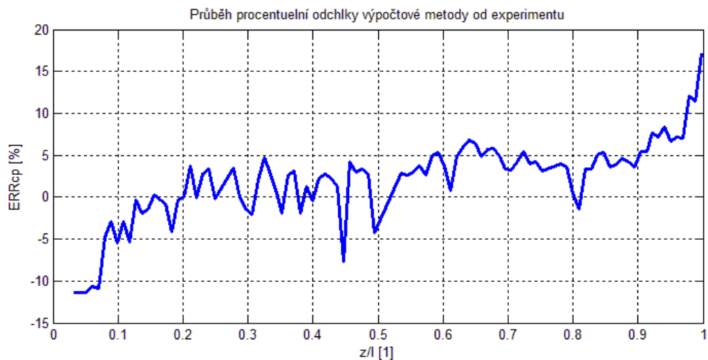
Obr. 8.13: Procentuální rozdíl mezi experimentálními a výpočtovými hodnotami c_p při 4^\circ
