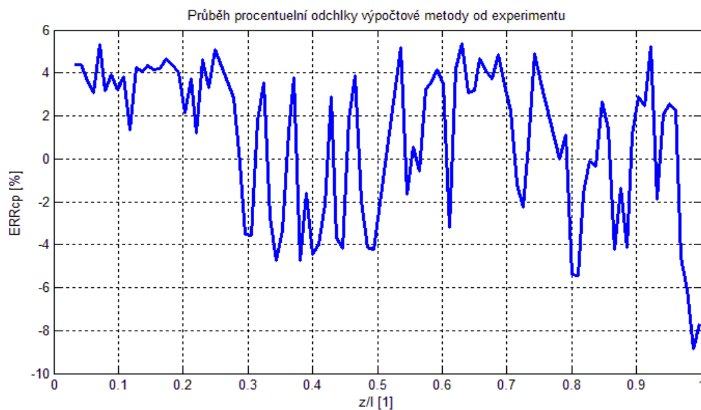
Obr. 8.9: Procentuální rozdíl mezi experimentálními a výpočtovými hodnotami c_p při 0^\circ
