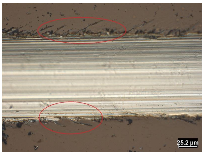
Obrázek 12: Porušení adheze povlaku k substrátu při zatížení 55 N
