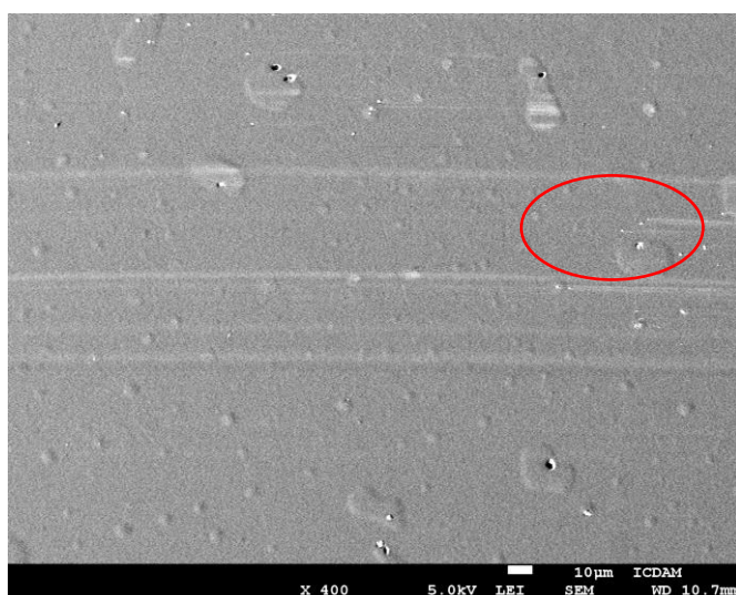
Obrázek 15: Stopa na Ti-C:H v oleji + Cera Tec a viditelnost keramických částic
