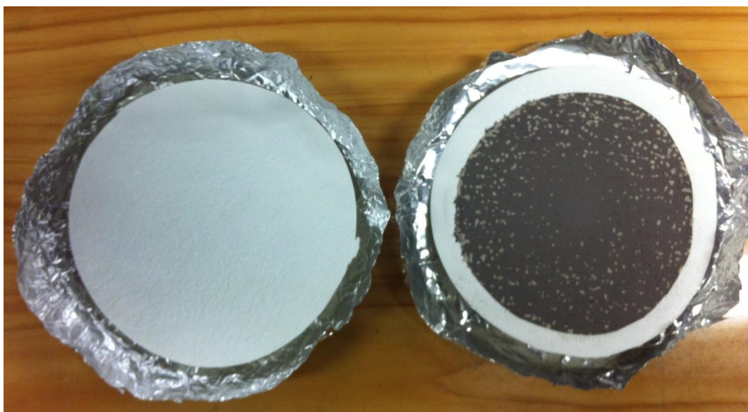
Obr. 9.4 Filtr před (vlevo) a po expozici prachové směsi (vpravo)
