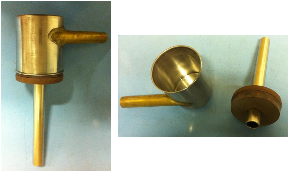
Obr. 10.3 Ukázka cyklónu D73 ve složeném (vlevo) a rozloženém stavu (vpravo)
