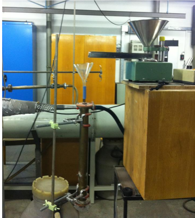
Obr. 9.2 Soustava na podávání prachu do potrubí
