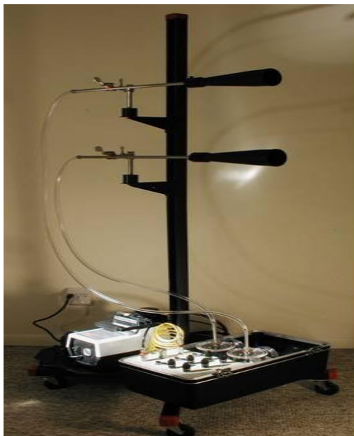
Obr. 4: Mobilní generátor heliových bublin [10]
