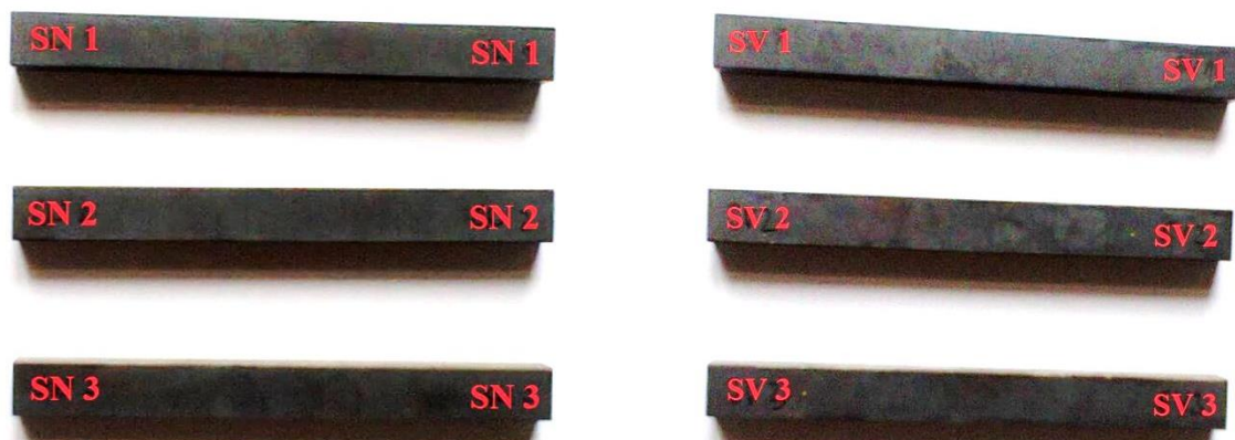
Obr. 11 Materiál X210Cr12 vzorky pro zkoušku třibodovým ohybem po kalení do soli
