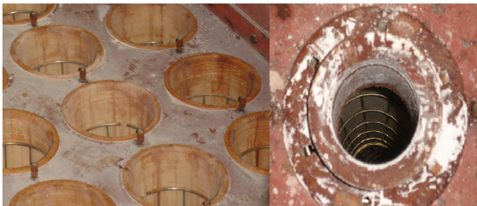
Obr. 20 Sestavení hadice, drátěné vestavby a dýzového nástavce
