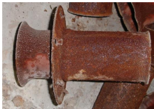
Obr. 19 Dýzový nástavec (Venturiho dýza)
