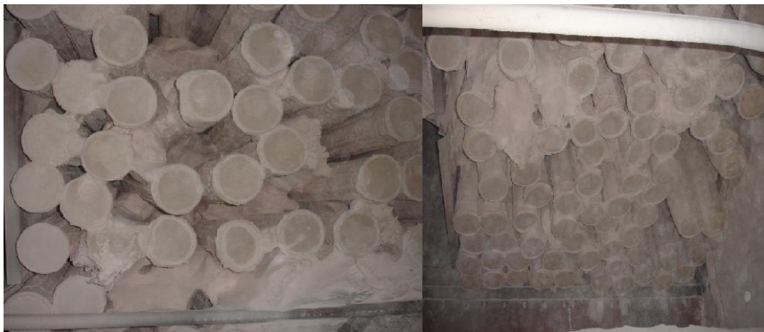
Obr. 25 Zalepené filtrační hadice
