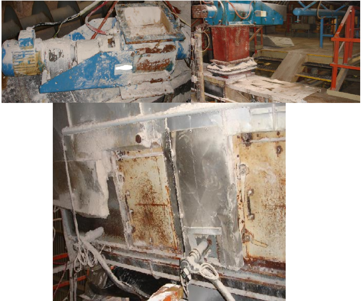
Obr. 24 Turniket (vlevo) a rozvod tlakového vzduchu na profuk boků dna (vpravo a dole)
