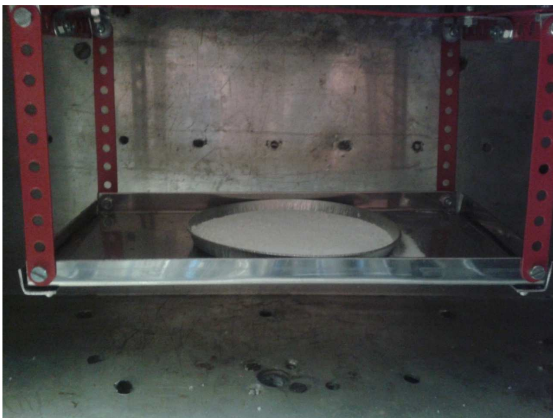
Obr. 8-4: Umístění vzorku sušeného materiálu v sušicí komoře.
