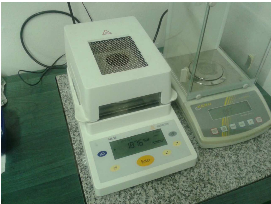
Obr. 8-1: Elektronický analyzátor vlhkosti Sartorius Model MA35.
