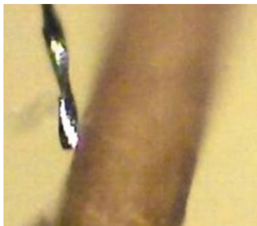
Obr. 03. Porovnání řezného nástroje s velikostí lidského vlasu (průměr nástroje 0,01 mm)
