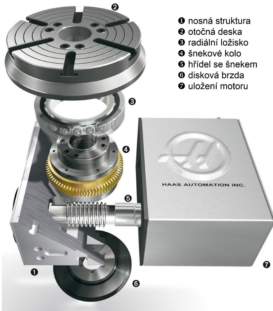
Obr. 19 Rozvin pohonu děličky z produkce firmy Haas [Haas Automation]
