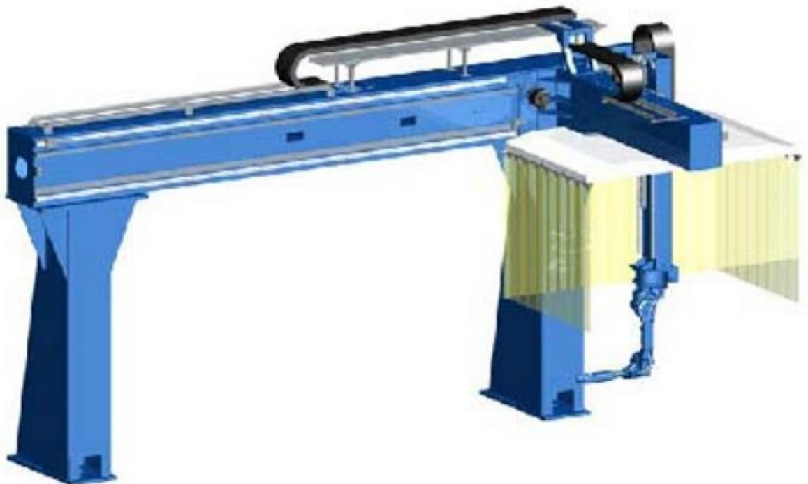
obr. 4-8: Více-osá pojezdová dráha s robotem f. Yaskawa [7]
