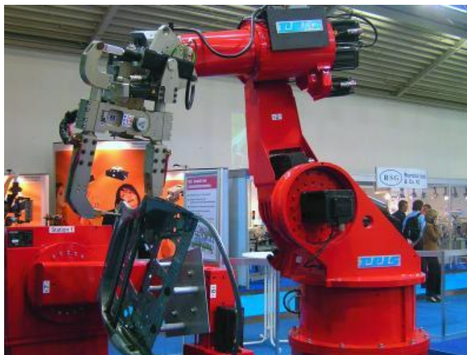
obr. 3-2: Robot s technologickou hlaví pro bodové svařování [9]
