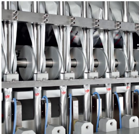
Obr. 2.4 Tvarování folie na víceřadém stroji a celý víceřadý stroj [8]
