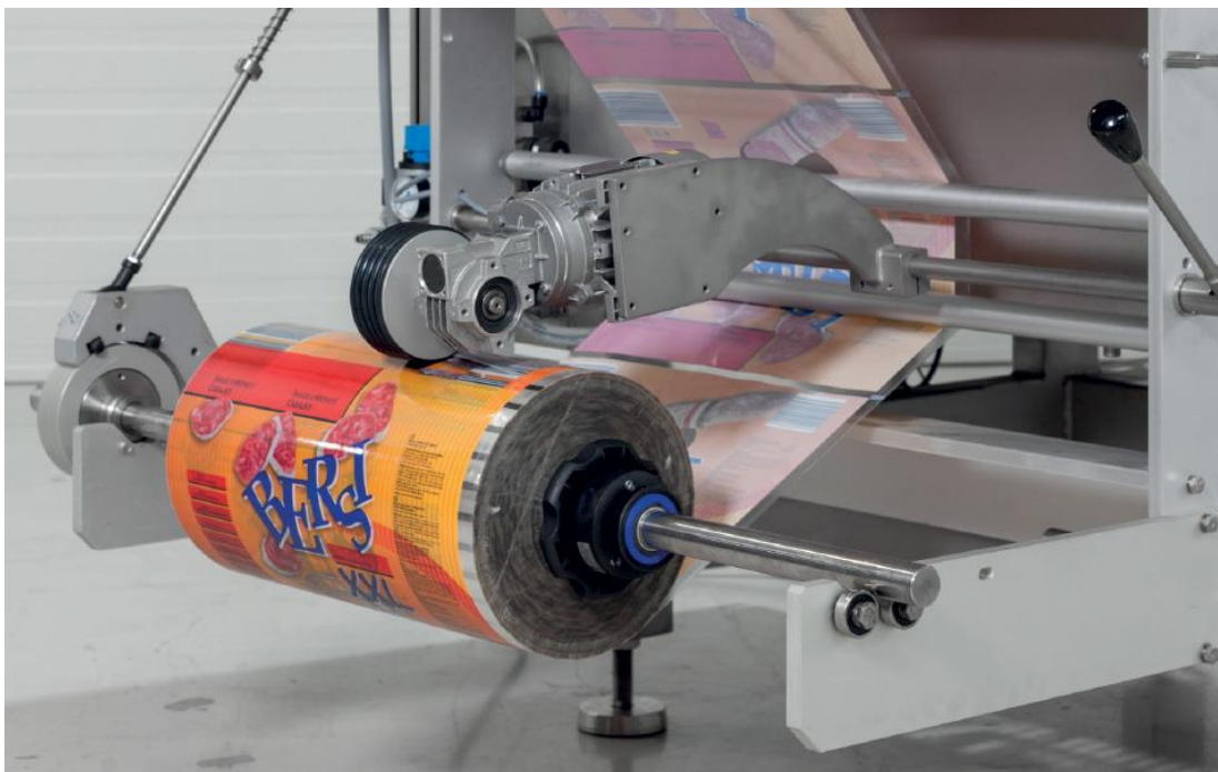
Obr. 2.9 Pohon svrchní vrstvy folie na cívce [14]
