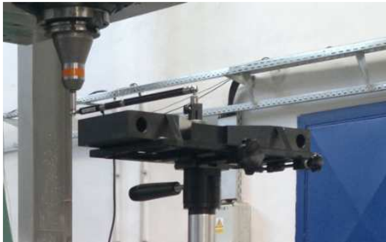
Obr. 8.6 Měření KI ball barem
