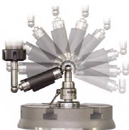
Obr. 3.3 Možnost měření ortogonální roviny systémem ballbar QC20-W [7]
