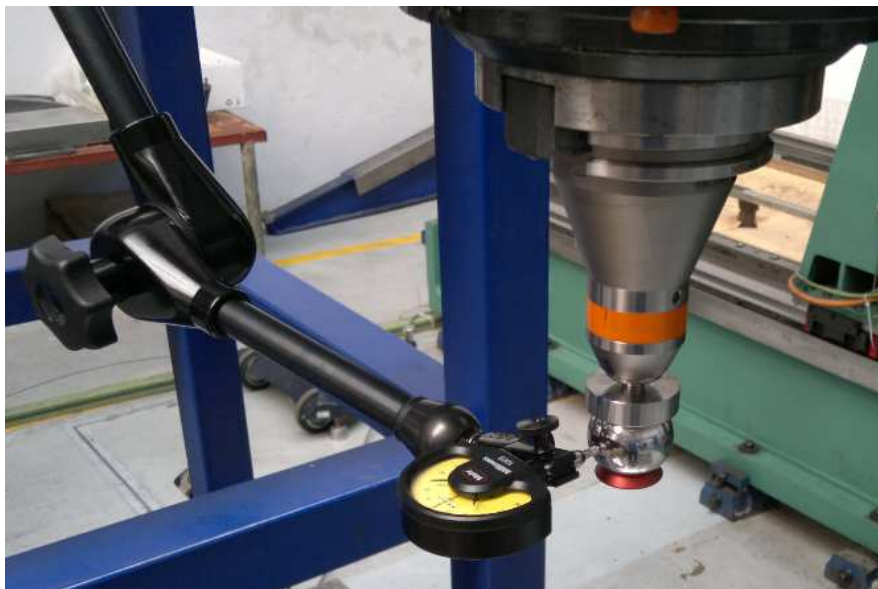
Obr. 8.1 Měření obvodového házení
