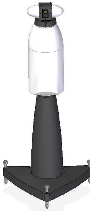
Obr. 4.2 Zjednodušený 3-D model laser trackeru LEICA AT901
