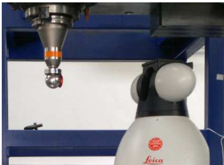
Obr. 8.3 Měření KI laser trackerem
