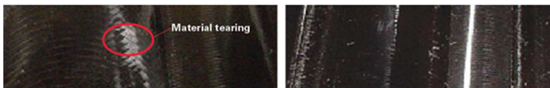
Obr. 37: Porovnání kvality povrchu při použití kuličkového a hydrostatického vedení na stejném stroji [26]
