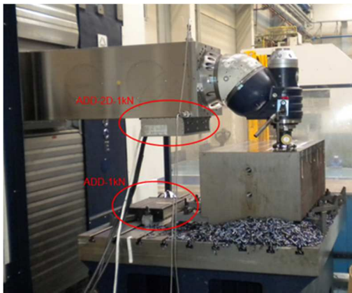
Obr. 40: Využití dynamického tlumiče na smykadlo horizontálního frézovacího stroje [29]
