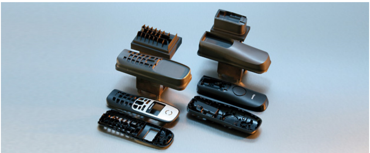
Obrázek 17: EDM - nástroje pro výrobu formy na těla telefonů (na obrázku nahoře), [12]
