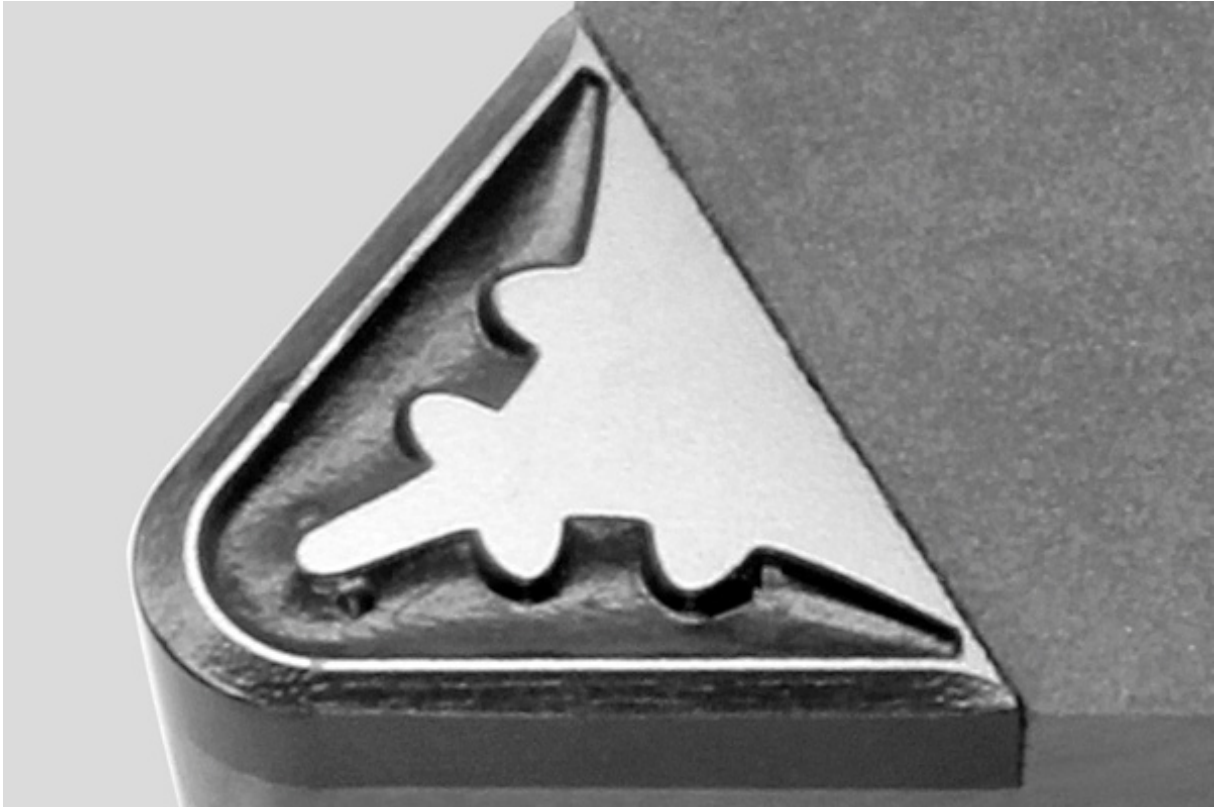
Obrázek 20: LASER - vzor pro přerušování třísky na CBN destičce, [13]
