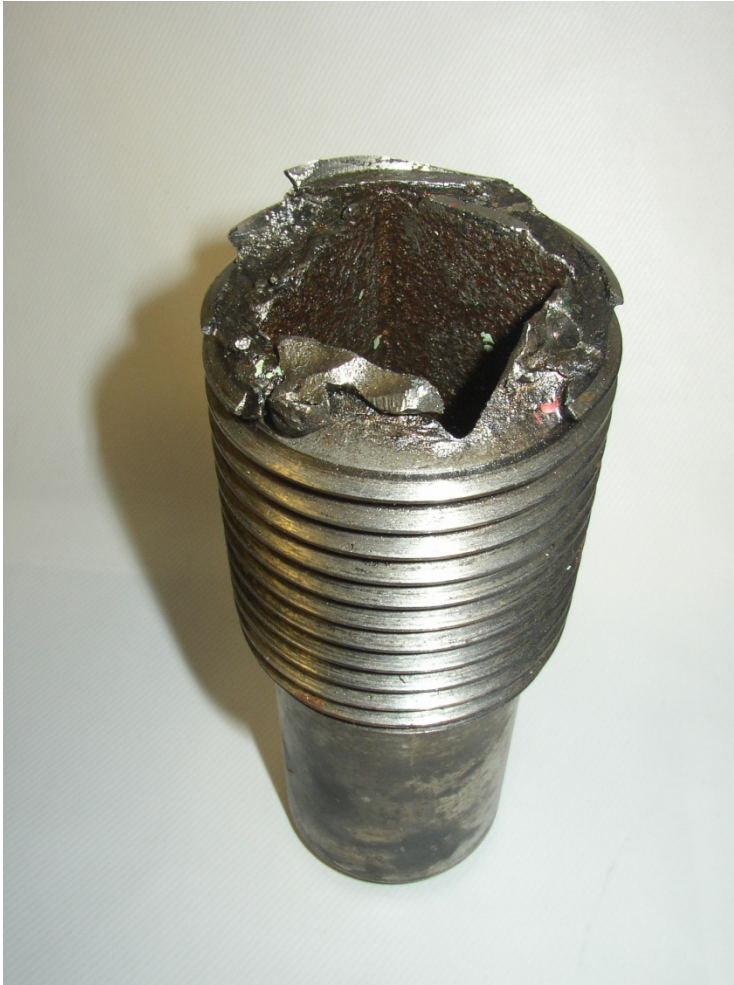
Obrázek 16: EDM - otvor pro povolení zalomeného šroubu M72 v lodním motoru, [11]
