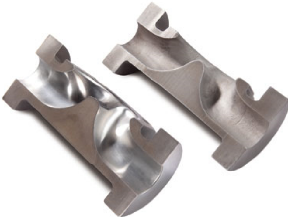
Obrázek 8: AFM - příklad obrobku před a po obrábění, [8]
