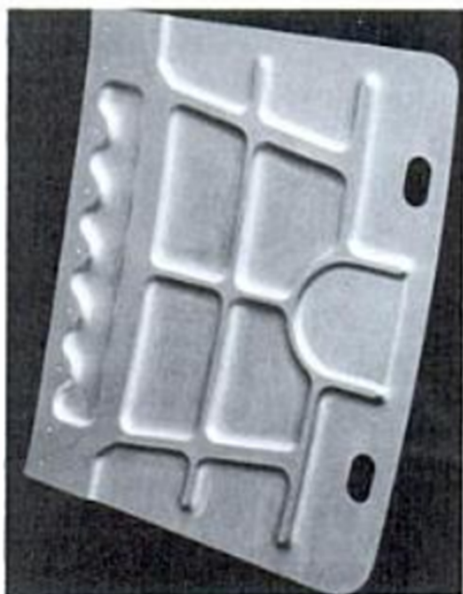
Obrázek 11: CM – hliníkové dveře motorového prostoru Boingu 747 po obrábění, [9]
