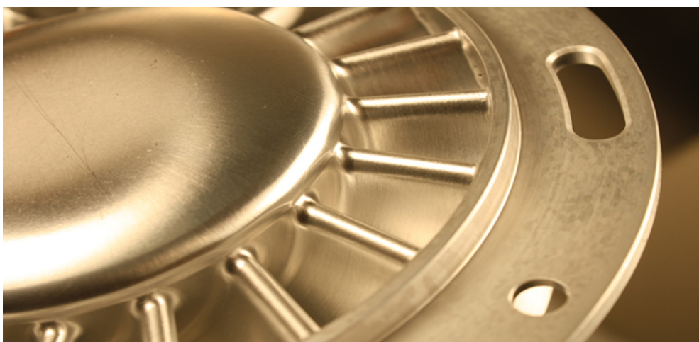
Obrázek 6: AFM - Lopatky turbíny po obrábění, [21]
