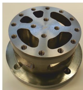
Rozvodný díl s příšroubovaných zadním víkem
