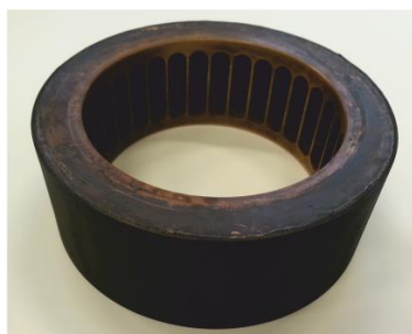
Navulkanizovaný věnec s drážkami
