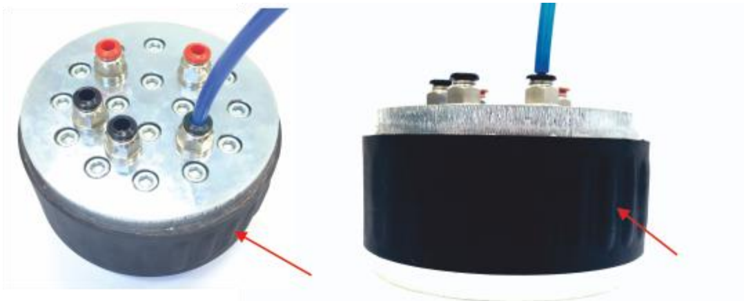
Obr. 5.24 - Nafouknutý vnitřní rotující buben s vyznačenou vyboulenou pryží
