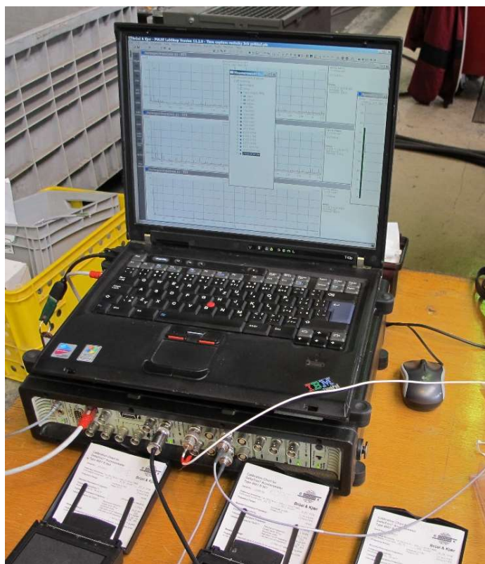
Obrázek 5-1 Přístroje pro měření vibrací s analyzátozem PULSE
