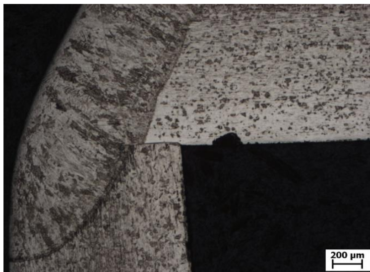
Obr. 33 - Rohový svar víko-plášť vzorek č. 1; svařováno s formovacím plynem; výkon 2500 W, fokusace + 12, rychlost svařování 25 mm/s; 25x zvětšeno
