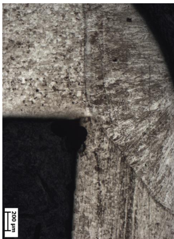
Obr. 34 - Rohový svar víko-plášť vzorek č. 2; svařováno s formovacím plynem; výkon 2500 W, fokusace + 12, rychlost svařování 25 mm/s; 25x zvětšeno
