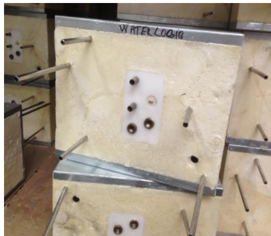
Obr. 14 – Blok zaizolovaný v PUR pěně
