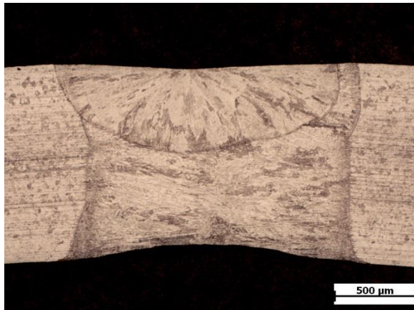
Obr. 38 – Tupý svar vzorek č. 1, bez formovacího plynu; 1. vrstva – výkon 2100 W, fokusace + 4,7, rychlost svařování 30 mm/s; 2. vrstva – výkon 1300 W, fokusace + 8,5, rychlost svařování 40 mm/s; 25x zvětšeno
