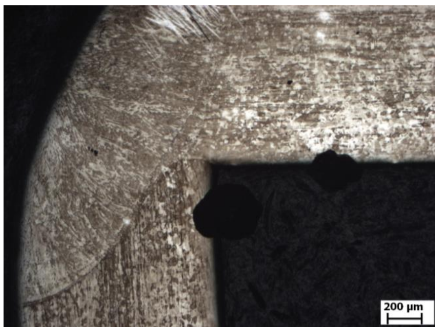
Obr. 36 - Rohový svar víko-plášť vzorek č. 4; svařováno bez formovacího plynu; výkon 2500 W, fokusace + 12, rychlost svařování 25 mm/s; 25x zvětšeno
