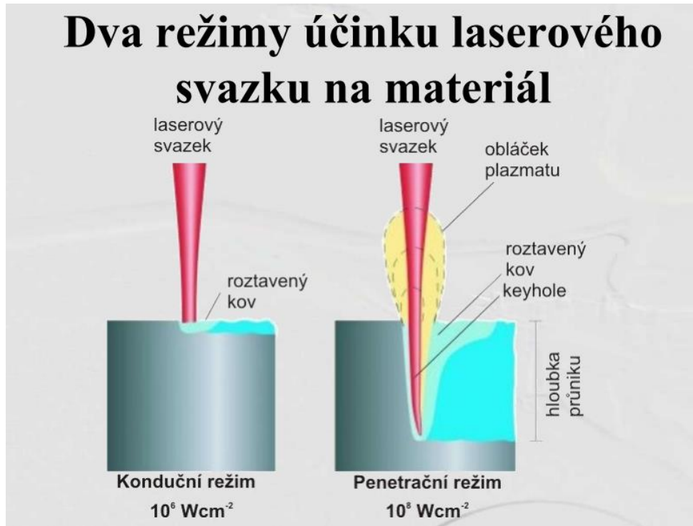
Obr. 2 – Dva režimy laserového svařování (12)
